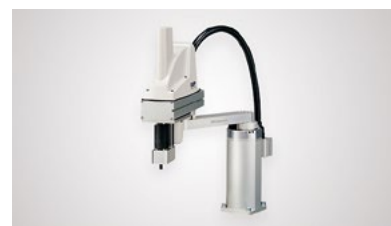
De 3 ejes con protección frente a polvo/salpicaduras
