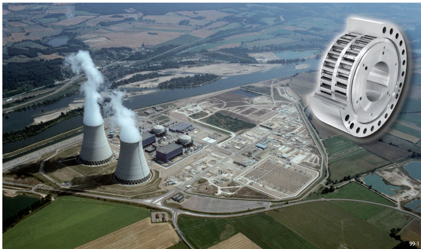
Antirretroceso FXM 2.410 - 100 LX para la bomba primaria de agua de refrigeración en una central nuclear. Par máximo 500 000 Nm. Velocidad 1485 min -1 , en servicio desde 1996. Fabricado y probado, y con documentación extensa de RINGSPANN GMBH, Bad Homburg.
