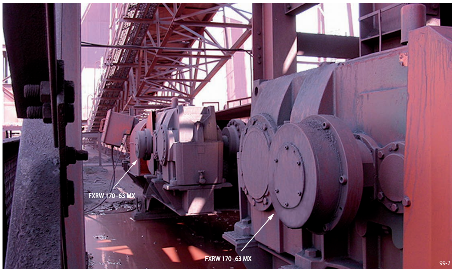
Instalación de cintas transportadoras para mineral de hierro en Sudáfrica accionadas por tres reductores con antirretrocesos FXRW 170 - 63 MX de RINGSPANN.
