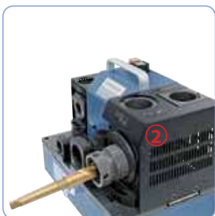
1. Rectificado del ángulo de punta Ø 2 - 13 mm 2. Rectificado del ángulo de punta Ø 8 - 32 mm
