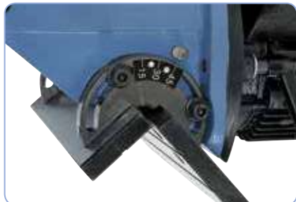
Ajuste continuo del ángulo de achaflanado de 15° a 45°
