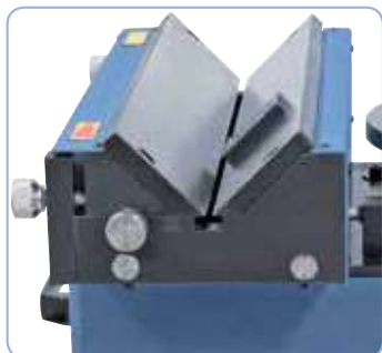
Fácil ajuste del ancho del chaflán gracias a la guía tope móvil.
