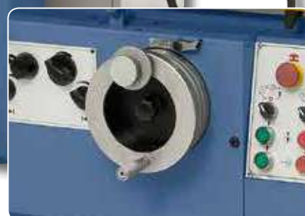
Volante con escala graduada (0,005 mm) para el movimiento transversal manual del cabezal de rectificado
