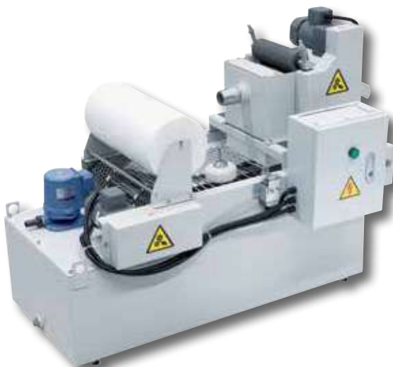
Opcional: dispositivo de refrigeración con aspiración, separador magnético y filtro de papel
