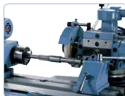
Rectificado cilíndrico exterior
