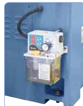
Lubricación automática para todas las guías y husillos
