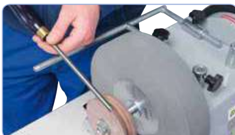
05-1809A disco reafilador de cuero: para reafilado y pulir las caras internas de los instrumentos de torneado, palancas y patas de cabra
