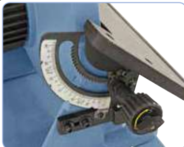
Mesa de fundición gris rectificadora con una inclinación de -3^{\circ} a +45^{\circ}
