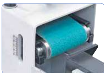
Ajuste en altura del rollo abrasivo para el lijado excéntrico
