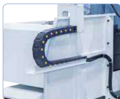
Incluye cadena para guiado de cables
