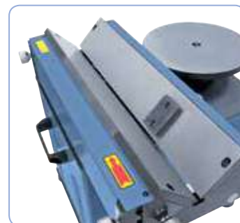
Guía rectificada con tope para de pieza.
