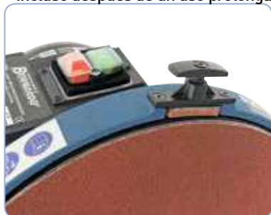
El freno manual detiene el disco de lijado en segundos
