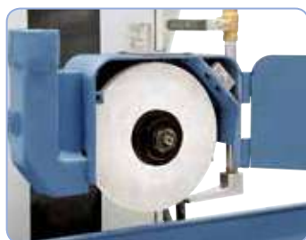
Funcionamiento con mínimas vibraciones y elevada precisión del husillo de rectificar mediante rodamientos pretensados.
