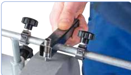
05-2058 dispositivo de diamantar: para dar forma circular o plana a la muela
