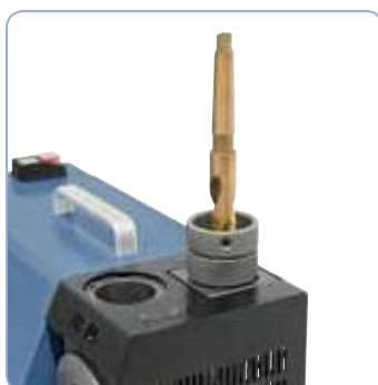
Rectificado en relieve del ángulo de incidencia
