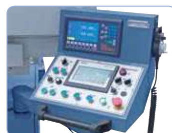
Disposición visible de los elementos de control en la consola giratoria
