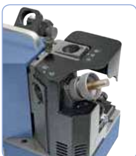
Afilado del ángulo de incidencia de fresas de 2 filos
