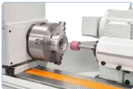
De serie con dispositivo de rectificado interior
