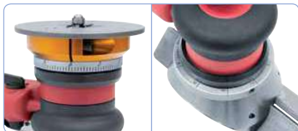
Ajuste continuo del ancho de chaflán mediante anillo graduado.
