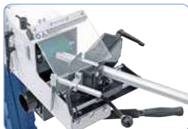
Dispositivo de lijado inclinable de 30° a 90°
