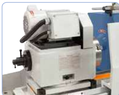
Cabezal giratorio entre 0° y 90° para rectificado cónico.
