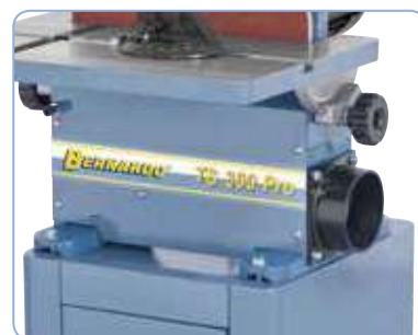
De serie con salida para el polvo en el cuerpo de la máquina
