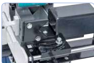
La lectura del ángulo de lijado se lleva a cabo mediante escala graduada
