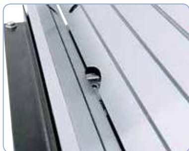
La altura del chaflán puede ajustarse de 0-3 mm de forma continua
