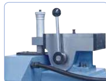
Dispositivo diamantador manual con ajuste micrométrico incluido en el equipo base
