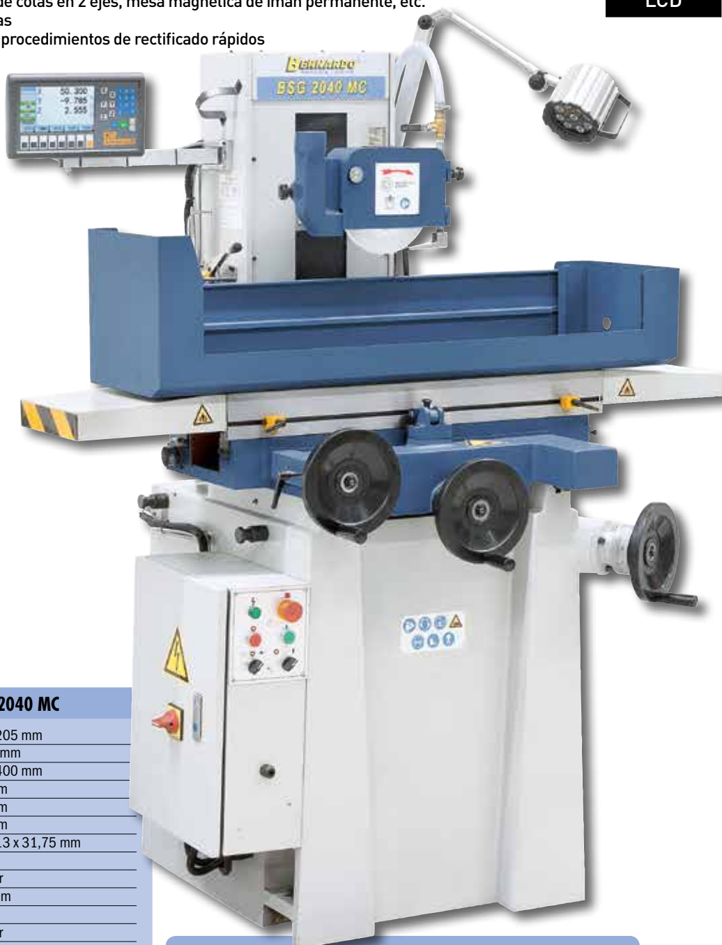
Funcionamiento con mínimas vibraciones y elevada precisión del husillo de rectificar mediante rodamientos pretensados.
