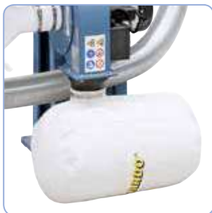
Reducido paso de polvo a través de la bolsa gracias al filtro de tejido fino
