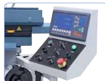
Visualizador de cotas LCD en 2 ejes con incluido en el equipo base
