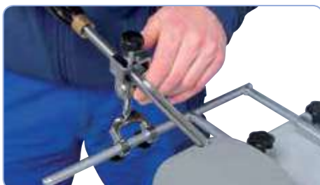
05-2052 dispositivo para herramientas de torneado: diámetro máx. de la herramienta 20 mm
