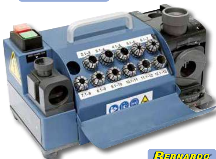
Estaciones para el afilado del filo transversal y afilado en relieve del ángulo de incidencia
