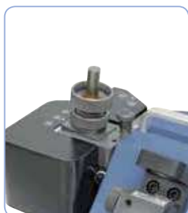
Afilado de los ejes de corte 1 y 3
