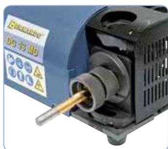
Rectificado del ángulo de punta
