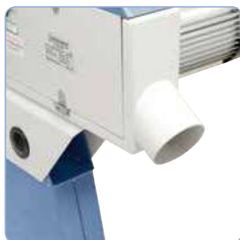
De serie con salida de polvo, diám. 100 mm
