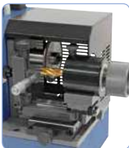
Afilado del filo de corte espiral exterior
