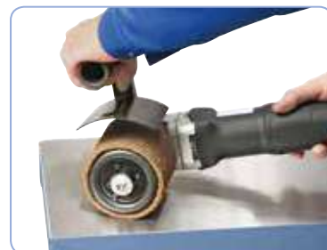
Con tambor de lijado de goma inchable opcional, el colchón de aire se adapta a la superficie de la pieza de trabajo
