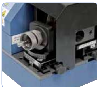
Afilado de la longitud de corte
