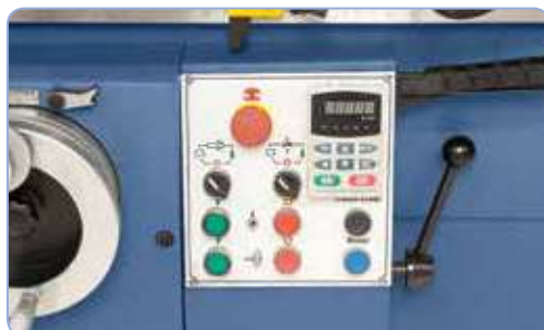
Consola de control electrónica dispuesta de forma ergonómica y visible
