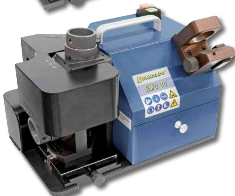
Afilado del ángulo de incidencia de fresas de 2 filos
