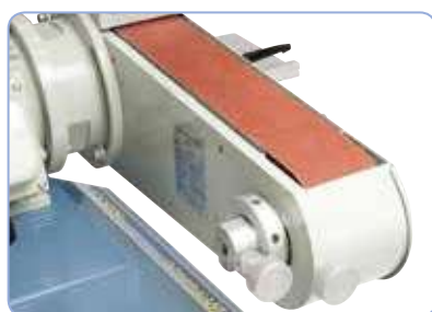
Gran superficie de rectificado plano con tope de la pieza de trabajo
