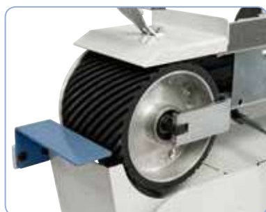
Disco de contacto de 70° a 74° Shore A, óptimo para desbastes
