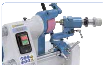
Asiento de la fresa cilíndrica frontal
