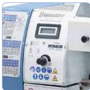
Regulación electrónica de revoluciones, fácil lectura mediante visualizador digital
