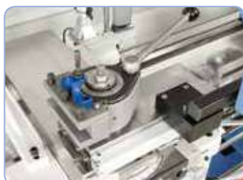
Para aumentar la eficiencia en el trabajo, la máquina está equipada de serie con un portahtas. de cambio rápido
