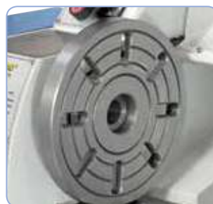
Para sujetar piezas de trabajo con forma especial, la máquina puede equiparse con un plato liso de 240 mm.
