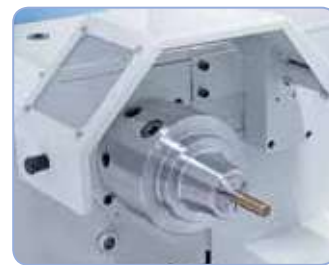
Opcional: portapinzas 5C, capacidad de sujeción 3 - 26 mm
