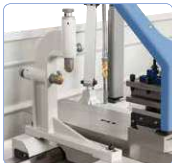
Las lunetas móviles impiden la flexión de los ejes finos.
