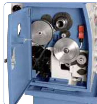
El equipo base incluye los engranajes de cambio para roscado
