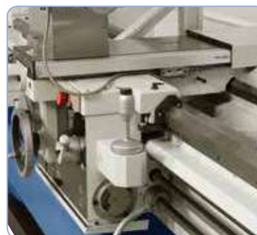
Incluye marcha rápida para el movimiento longitudinal y transversal del delantal.
