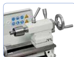
Opcional: punto giratorio tipo SMA con 7 puntas intercambiables
