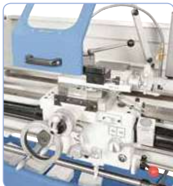
Dispone de 42 avances longitudinales y transversales
