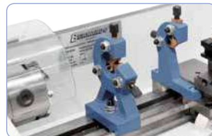
Las lunetas facilitan el trabajo con piezas largas.
