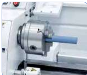
Paso de barra de 38mm, para mecanizar barras de grandes diámetros (700 Top)
