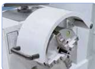
Plato de 4 garras autocentrante de 200 mm, para sujetar piezas cuadradas (opcional)
