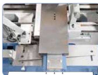
Dispositivo opcional de torneado cónico, longitud de mecanizado 455 mm, ángulo de ajuste \pm 8^\circ
