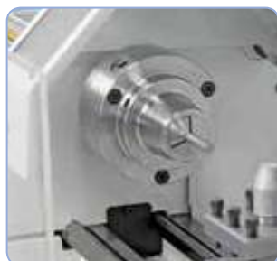
Opcional: portapinzas 5C, capacidad de sujeción 3 - 26mm
