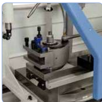
El portaherramientas de cambio rápido permite una reducción de tiempos muertos y garantiza una alta precisión de repetición.
