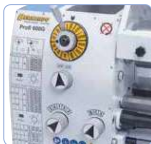
Cambio de velocidades mediante palanca para un cambio rápido y sencillo
