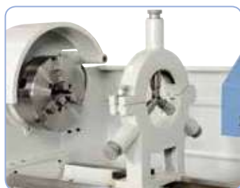
Luneta fija para el amarre de piezas de trabajo largas
