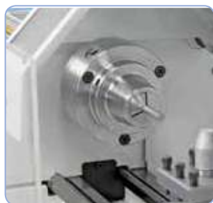
Opcional: portapinzas 5C, capacidad de sujeción 3 - 26mm
