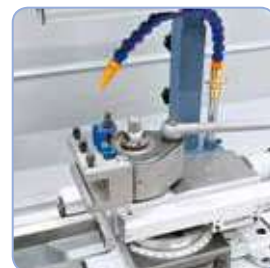
Para un trabajo más eficiente, la máquina se puede equipar con un portaherramientas de cambio rápido
