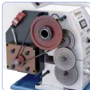
De serie equipado con engranajes de cambio para roscado.
