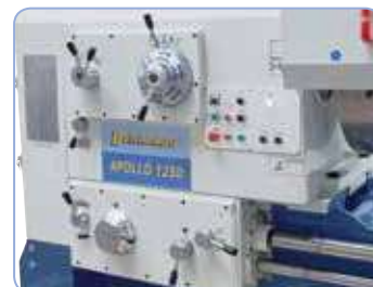
Botones colocados de forma visible en el cabezal, las ruedas dentadas templadas y rectificadas garantizan un funcionamiento silencioso.
