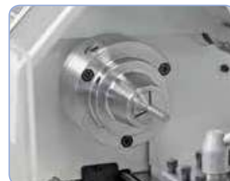
Opcional: portapinzas 5C, capacidad de sujeción 3 - 26 mm
