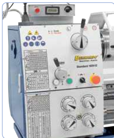
Fácil manejo, todos los elementos de control están dispuestos de forma visible en el cabezal.
