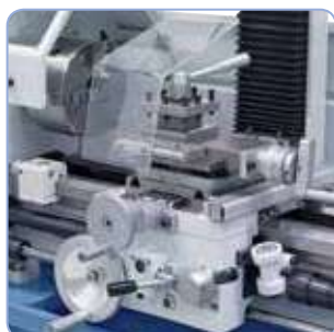
Los volantes del delantal tienen nonius y avance automático
