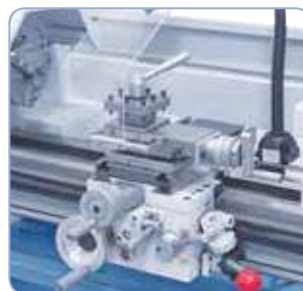
Ajuste suave del delantal con carro superior y portahatas. de 4 posiciones, volantes con nonius ajustable.
