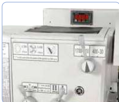
Regulación electrónica de las revoluciones, fácil lectura mediante visualizador digital.
