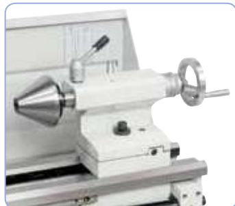
El contrapunto con fijación por palanca se puede desplazar lateralmente para torneado cónico, el punto giratorio para tubos es opcional.
