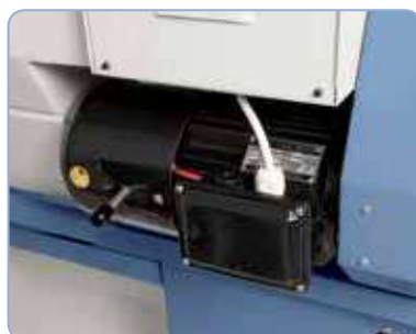
Potente motor principal con freno magnético conforme a la normativa de la CE
