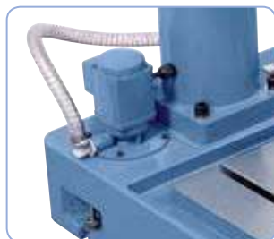
Bomba de refrigerante potente incluida en la entrega
