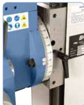
Guía de cola de milano que no requiere mantenimiento con regleta de cuña
