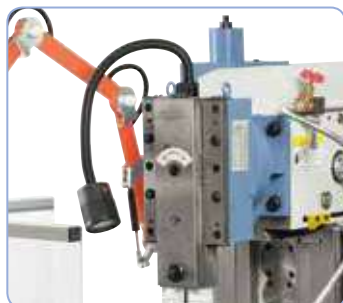
El cabezal de mortajar (opcional) con carrera ajustable puede inclinarse a derecha o izquierda
