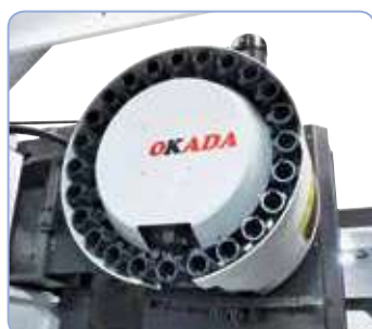
Con cambiador de herramientas de 24 estaciones de serie.
