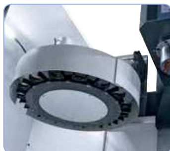
Cambiador automático de 16 herramientas con cambio rápido.
