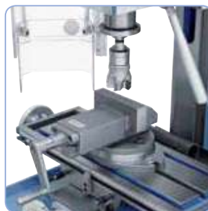
Fresado con fresa de planear y cantear (n.º ref. 42-1057)
