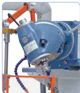
Cabezal portafresas universal ajustable en diferentes ángulos
