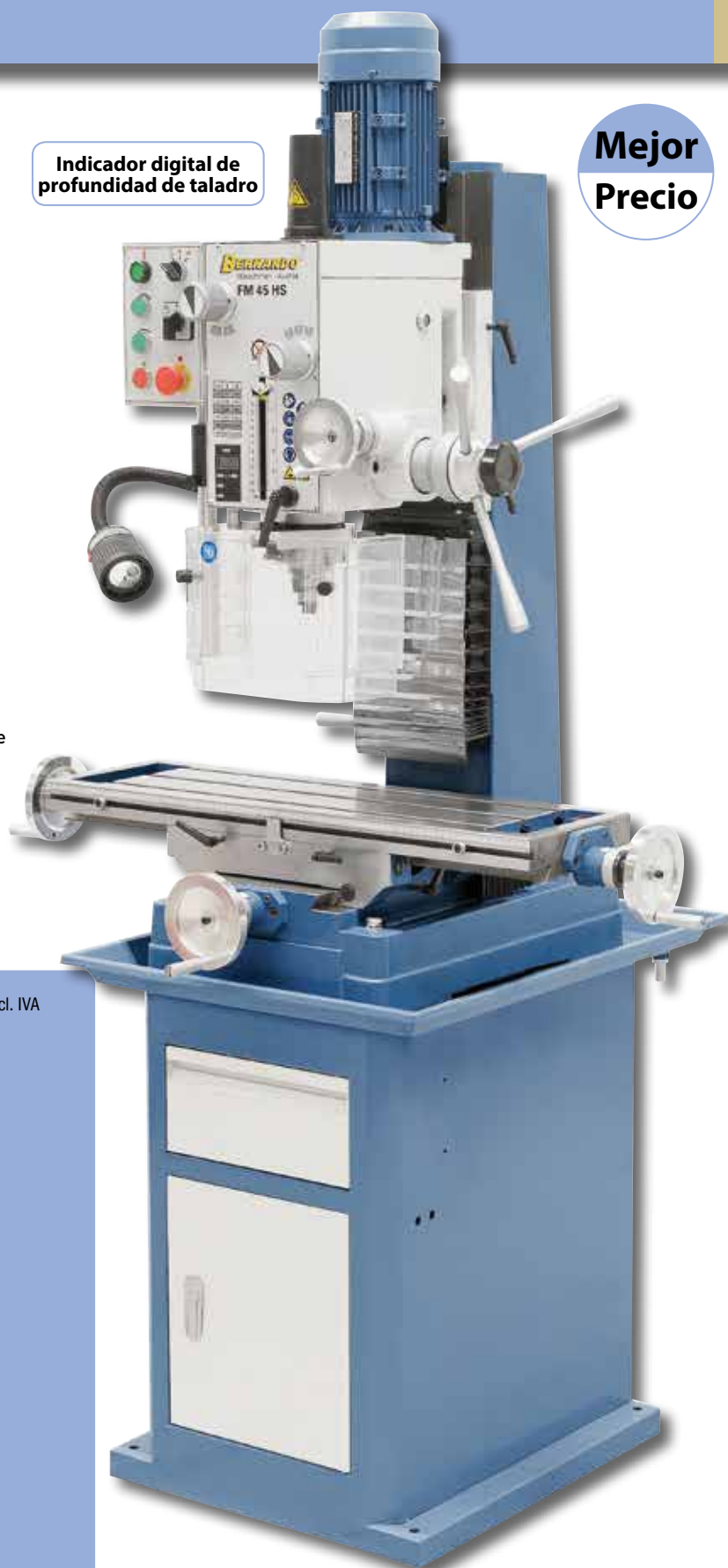
Mandos de control de fácil acceso (roscado, marcha/paro, etc.)
