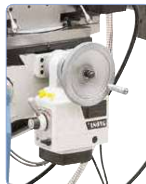
Avance longitudinal en el eje Y con marcha rápida de serie
