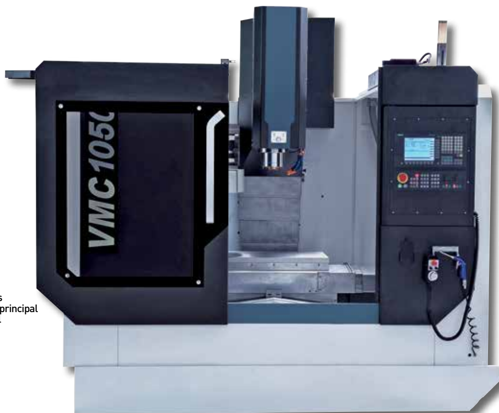
Cambiador automático de 16 herramientas con cambio rápido.
