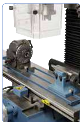
Divisor semi-universal BS-0 para el mecanizado de ejes.
