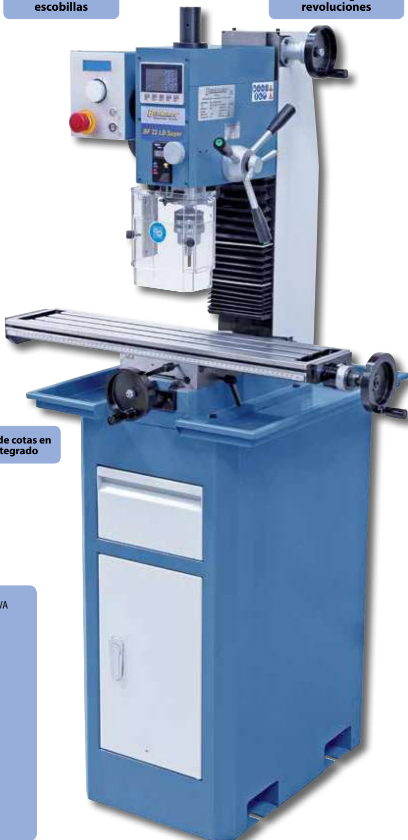
De serie: Indicador de posición de 3 ejes
