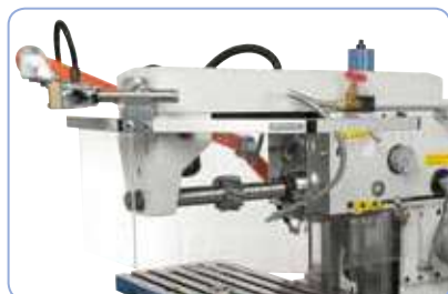
Fresado horizontal con contrasoprote
