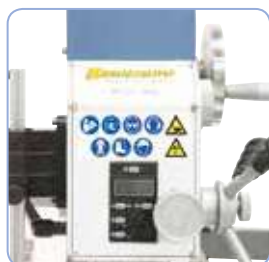
Indicador digital de carrera de pinola para un trabajo cómodo.
