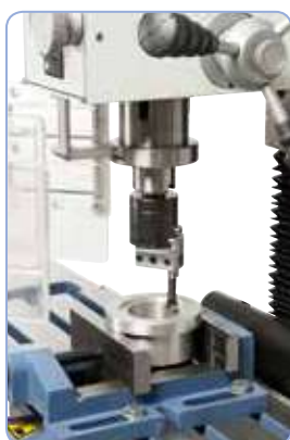
Si lo desea, la máquina se puede equipar con un cabezal de mandrinado.
