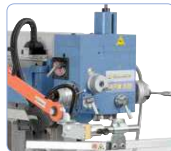
Cabezal portafresas vertical giratorio con carrera de pinola de 60 mm y tres avances automáticos de taladrado
