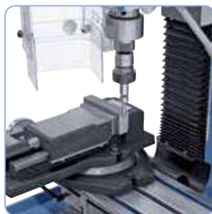
Accesorios especiales que pueden entregarse: Palpador de cantos
