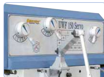
Sencillo uso de las palancas para cambio de revoluciones
