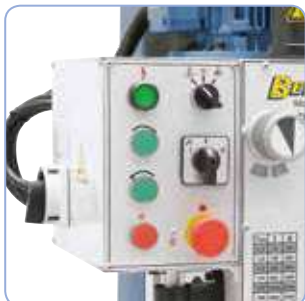
Mandos de control de fácil acceso (roscado, marcha/paro, etc.)
