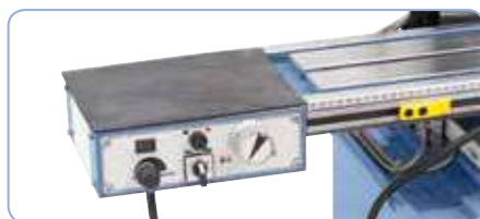
Indicador digital de carrera de pinola para un trabajo cómodo.
