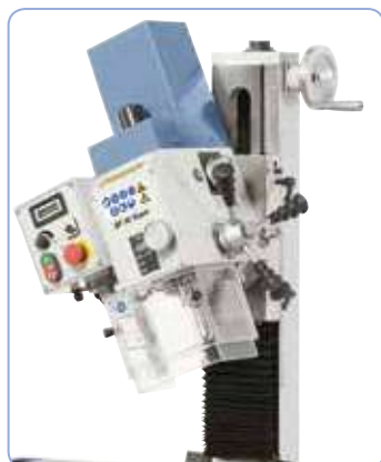
Cabezal inclinable a ambos lados +/-90°
