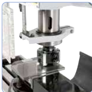
Fresado con cabeza de cuchilla
