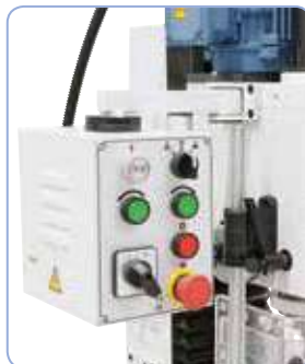
Controles de fácil acceso, incluye dispositivo para roscar
