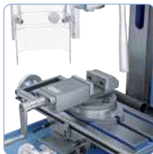
Fresado con mordaza de precisión PS 75
