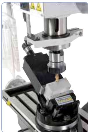
Fresado con mordaza inclinable y giratoria
