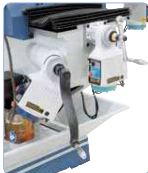
Completa con avance automático regulable en los ejes X, Y y Z
