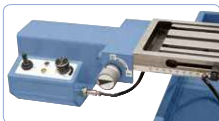
Mesa con avance automático regulable FTV 9
