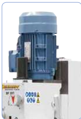
Potente motor de 2 velocidades de 0.75 / 1.1 kW
