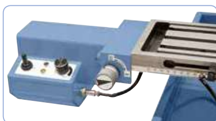
Mesa con avance automático regulable FTV 8.
