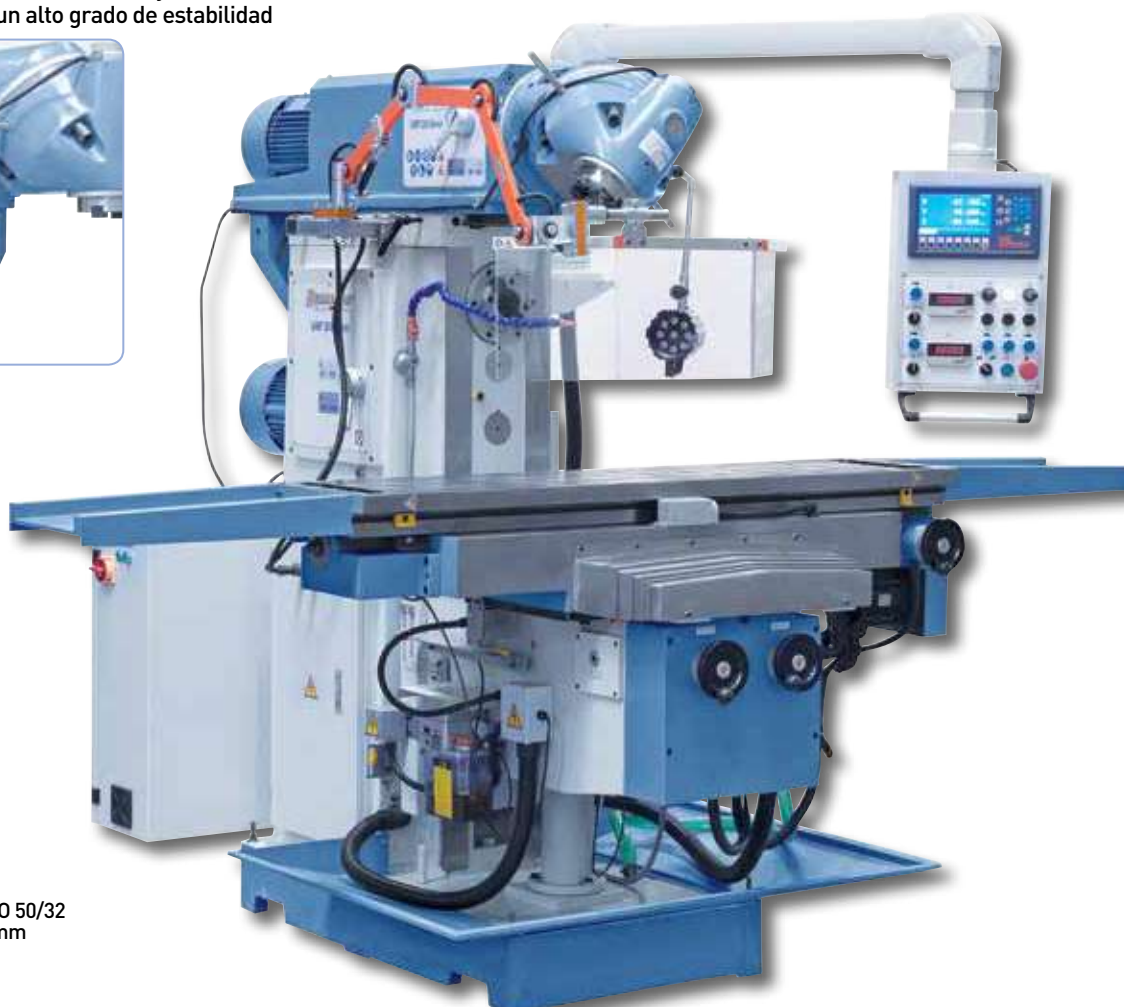
De serie con soporte y portafresas para fresado horizontal
