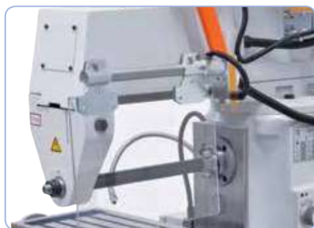
Soporte y portafresas para fresado horizontal de serie
