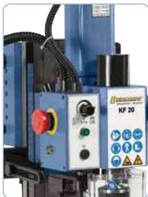
Regulación de revoluciones mediante engranaje intermedio y motor de corriente continua regulable de forma continua
