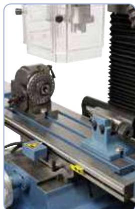
Aparato divisor semi-universal BS-0: óptima para el mecanizado de ejes
