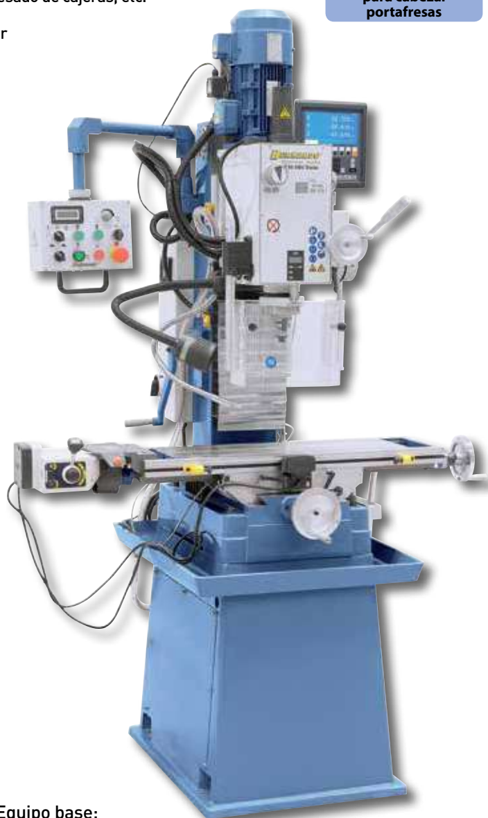
Gran mesa en cruz con ranuras en T y canales para recoger el refrigerante. Imagen con avance automático AL 450 D de serie
