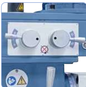
La accesibilidad de los controles permite un sencillo cambio de revoluciones
