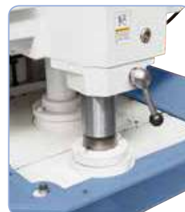
Bloqueo manual del eje Z para una mayor estabilidad
