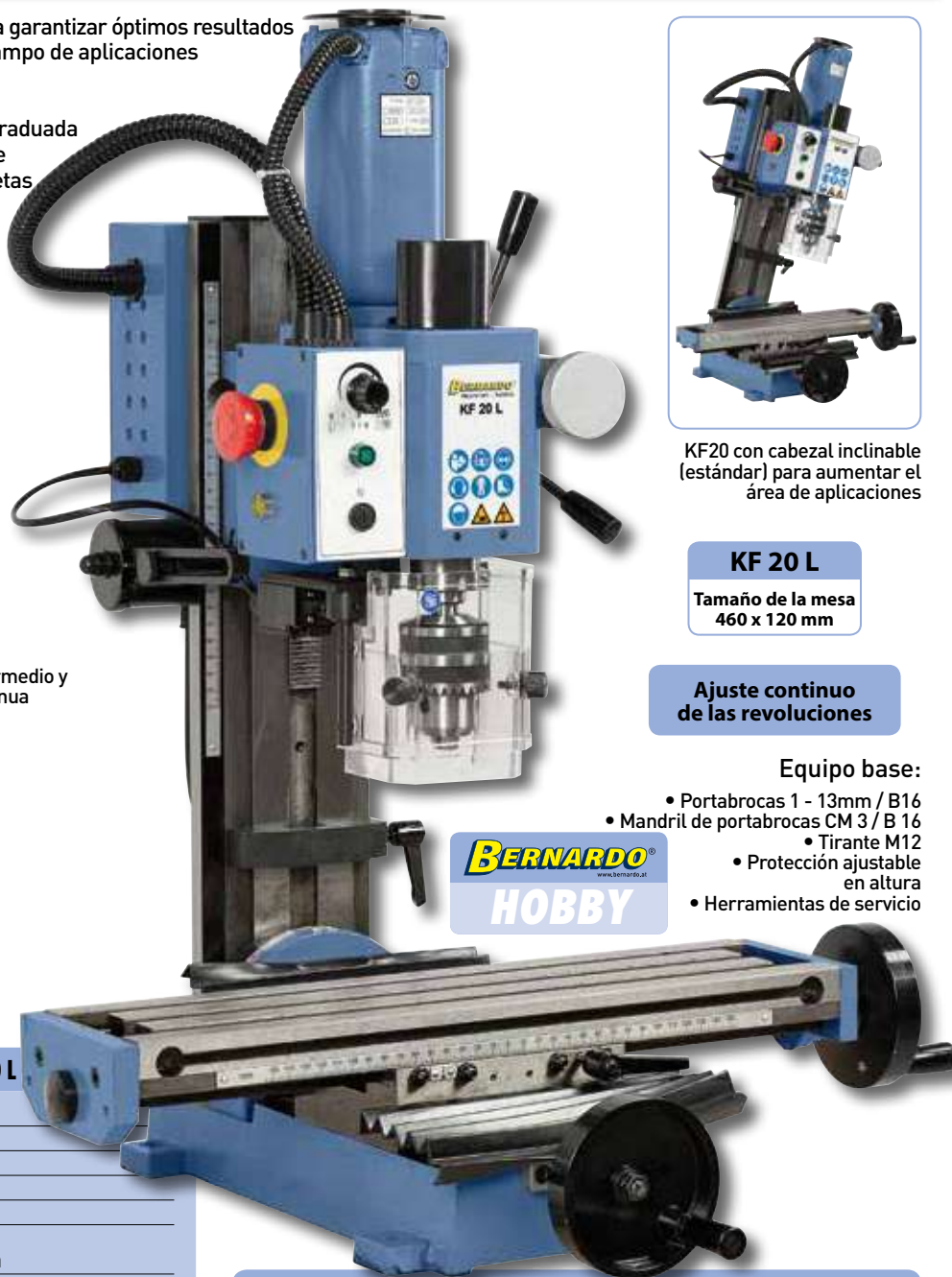
Mesa de cruz de fundición gris de alta calidad, avance de mesa de fresado FTV 1, opcional
