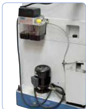
Lubricación central y sistema de refrigeración incluido en el equipo base
