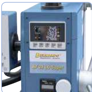
De serie: Indicador de posición de 3 ejes
