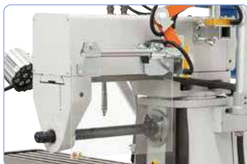
Soporte y portafresas para fresado horizontal de serie
