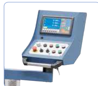
Elementos de control claramente dispuestos en la consola giratoria, de serie con visualizador de cotas LCD en 3 ejes
