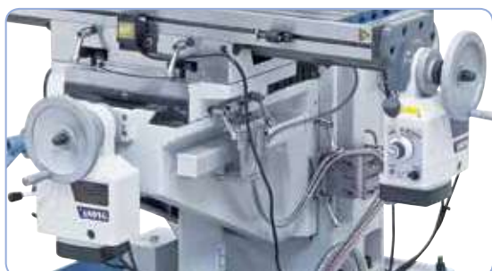
Avance automático en los ejes X e Y de serie
