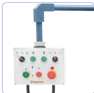
Consola de control inclinable con botones dispuestos de forma ergonómica
