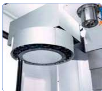
Cambiador automático de 16 herramientas con cambio rápido.
