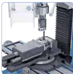
Si lo desea, la máquina se puede equipar con un cabezal de mandrinado.
