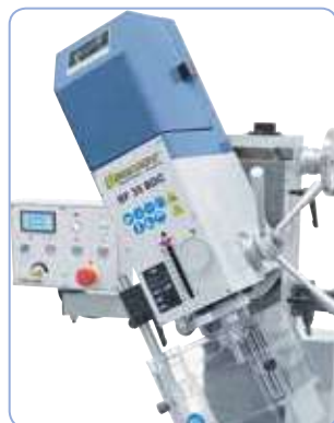
Cabezal inclinable a ambos lados +/- 90°
