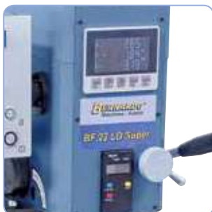
De serie: Indicador de posición de 3 ejes
