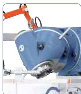
Cabezal portafresas universal ajustable para diferentes ángulos.
