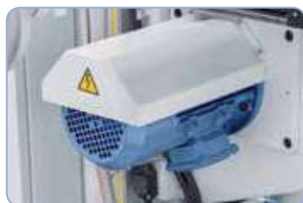
Motor de posicionamiento para ajuste de altura (eje z) de la mesa.
