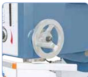
La carrera de la pinola de 100mm se realiza mediante un volante
