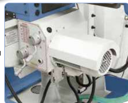
De serie con avance de 9 posiciones en los ejes X e Y
