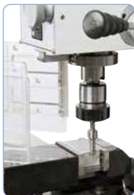
Accesorios especiales que pueden entregarse: Palpador de cantos
