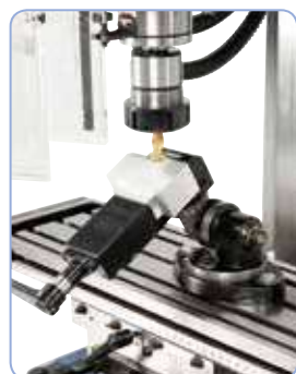
Fresado con tornillo de banco articulado PGS 50.
