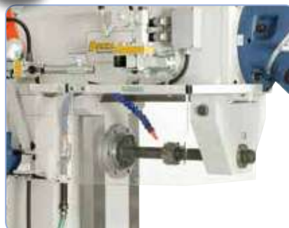
Completa con soporte horizontal y eje largo de fresar
