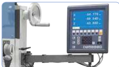
BF 30 Super con avance e indicador digital de 3 ejes ES-12 V con display LCD (n.º ref.: 02-1044C)
