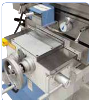
El diseño de las guías cuadradas sobredimensionadas en los ejes Y y Z, garantizan un alto grado de estabilidad
