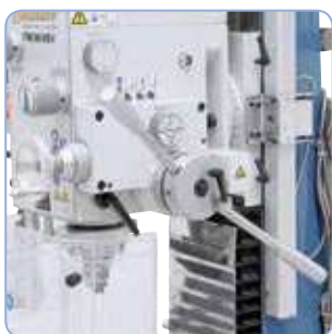
De serie viene equipada con avance de pínola automático triple.
