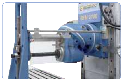
De serie con soporte y portafresas para fresado horizontal
