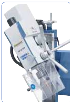
Cabezal inclinable a ambos lados +/-90°
