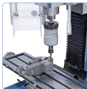
Para roscado la máquina se puede equipar con un aparato de roscar de M5 - M12.
