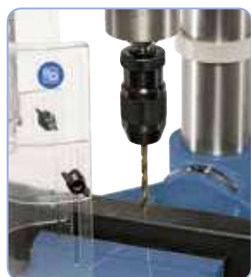
Trabajo preciso mediante el dispositivo láser de líneas cruzadas de serie
