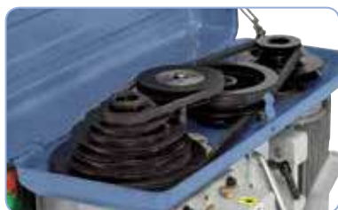
Funcionamiento muy silencioso gracias a los discos de accionamiento equilibrados.
