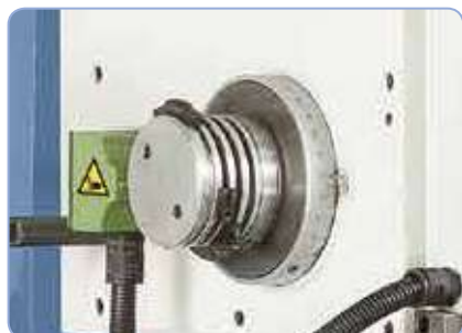
Mecanismo para roscar con avance rápido / avance de trabajo y retroceso rápido (de KBM 63).
