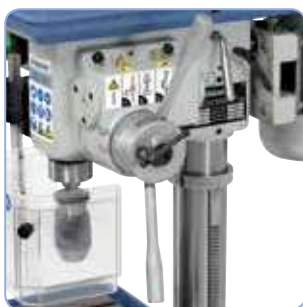
De serie viene con avance de pinola automático (V-modelos).
