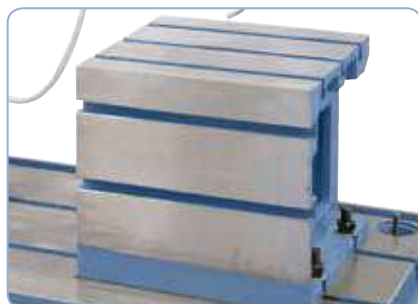
Mesa cúbica tallada con precisión con 5 ranuras en T, incluida de serie
