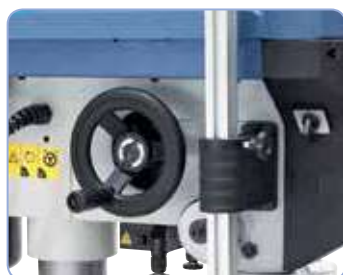
Volante posicionado lateralmente para el ajuste de las revoluciones deseadas
