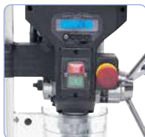
Botón de encendido y apagado conforme a IP 54 y botón de parada de emergencia de acuerdo con la normativa de la CE
