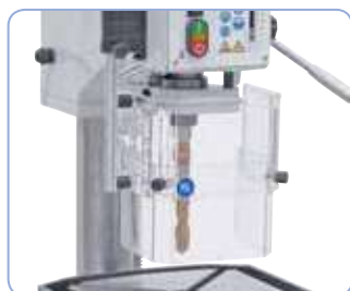
Protector de la caña según la normativa CE, ajustable a la longitud de la herramienta.
