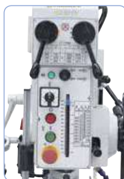
Cabezal de engranaje macizo con botones y elementos de operación dispuestos de forma ergonómica.
