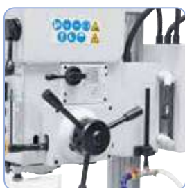
De serie viene equipada con 3 avances de taladrado automáticos.
