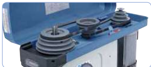
Las correas trapezoidales de alta calidad se encargan de una transmisión de la fuerza óptima
