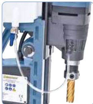
Lubricación interior automática. El refrigerante se conduce de forma directa al extremo de la fresa hueca
