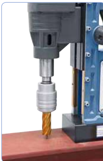
Broca sacanúcleos HSS, recubierta de TiN
