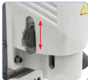
Cambio de 2 velocidades, revoluciones 230 / 550 rpm
