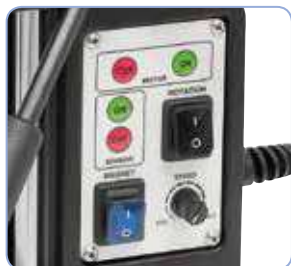
Elementos de operación dispuestos de forma visible.
