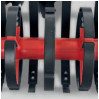
Elementos amortiguadores entre los anillos del compactador soportan la nivelación de la superficie.
