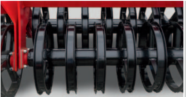
Compactador doble RollPack para un buen desmenuzado y una buena consolidación del suelo
