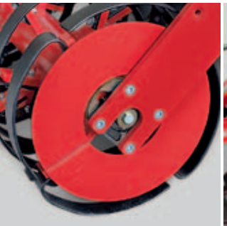
Las chapas laterales del RollFlex evitan la penetración de piedras en el compactador
