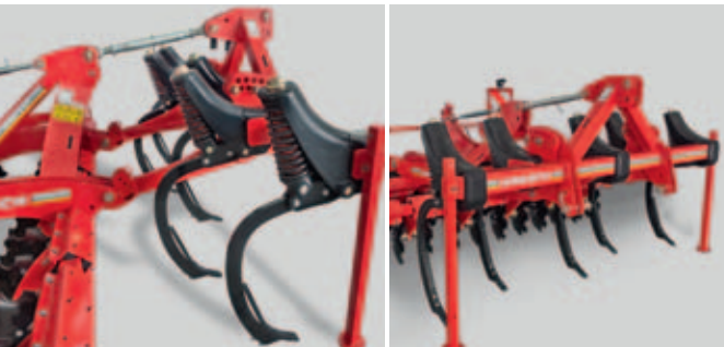
Mono TG: Óptimo para aflojar en la profundidad. Dientes TerraGrip con rejas LD (menor perturbación) aflojan el suelo en la profundidad, sin embargo no suben terrones gruesos.
