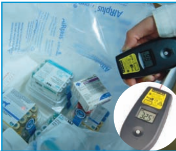
Los termómetros de infrarrojos son cada vez más empleados. Hay multitud de modelos y de diferente complejidad. Hay que tener presente que los infrarrojos consideran una superficie de medición variable en función de la distancia de la medición.
