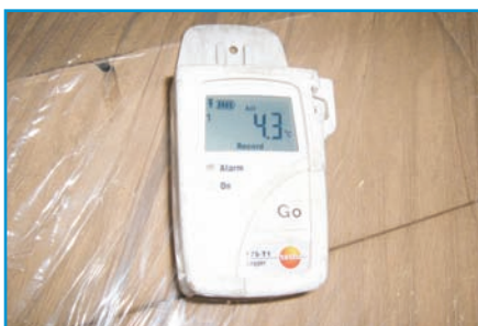
Estos medidores térmicos disponen de una prolongada autonomía permitiendo medir la temperatura de la mercancía constantemente.
