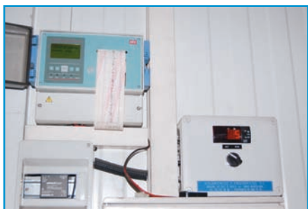
Termógrafo con registro térmico de impresión a papel. El sistema permite mantener el registro diario e incluso anual.
