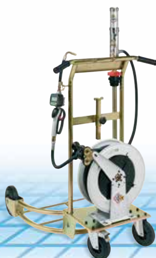
Plataformas móviles para suministro aceite con bomba R 3:1- 5:1 pistola cuenta-litros y enrollatubo
