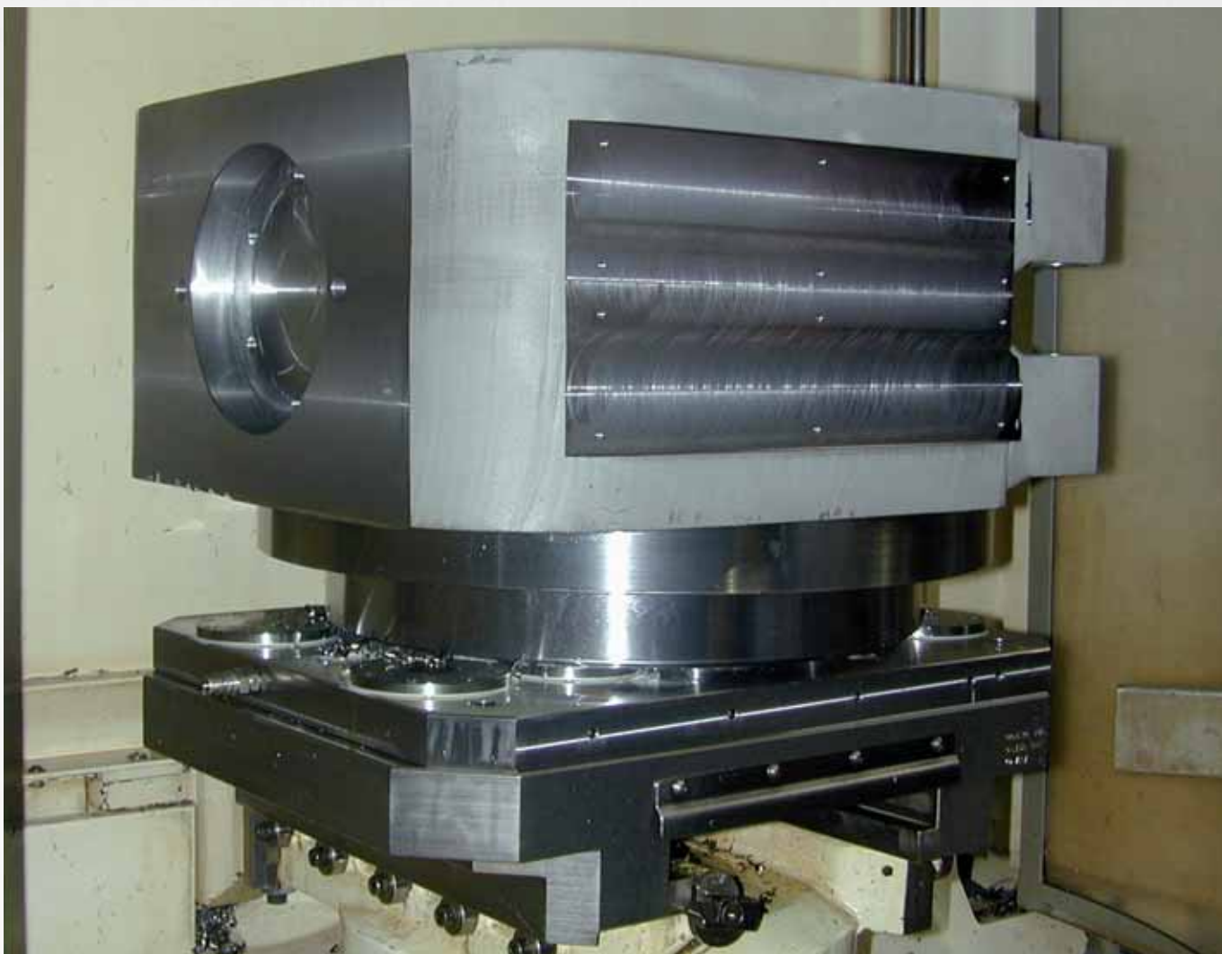
Las piezas grandes pueden sujetarse sin problemas. El sistema Zero-Point de AMF se adecúa muy bien para el uso bajo un considerable arranque de virutas de las 5 caras.
