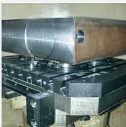
Módulos de fijación para estructura de AMF en funcionamiento bajo un considerable arranque de virutas.
