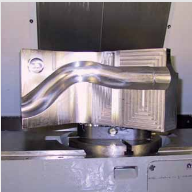
Pieza dotada directamente con boquillas de sujeción, gracias a ello es posible un mecanizado de la 5 caras.
