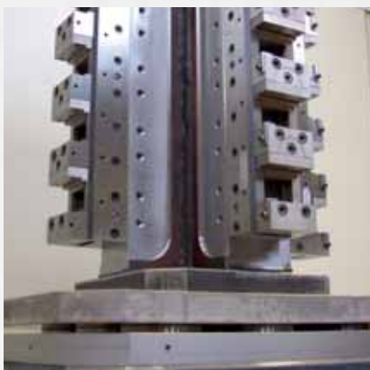
Dispositivo para sistema de sujeción múltiple, sujetado con módulos de fijación enroscables AMF.
