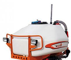
**Equipo auxiliar delantero**, incrementa la capacidad hasta 1.500 litros y sirve de contrapeso. Está diseñado para trasegar a gran velocidad su contenido al depósito posterior.
