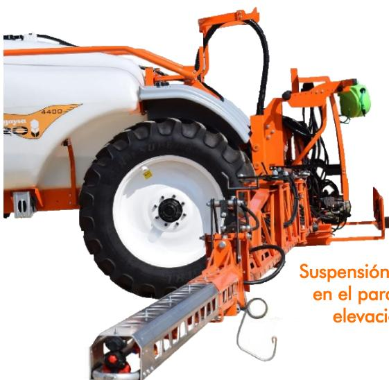
Suspensión oleo-hidráulica en el paralelogramo de elevación en barra
