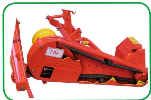
Das Mähwerk wird über die Verbindung einer Gelenkwellen an die Zapfwelle des Traktors angetrieben, welche den Kraftfluss über einen Riementrieb mit Riemscheibe, an die beiden getrennten Systeme Pleuel-Kurbeltrieb überträgt, welche zum Antrieb des Messers und der Finger dienen.
