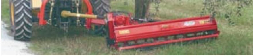
Trincatrice perfetta per trattori da 30 a 50 HP. La macchina agile ed efficiente, lavora con posizione fuori sagoma laterale per la pulizia di uliveti, frutteti, agrumeti etc. Assumendo diverse inclinazioni, segue bordi stradali, scarpate e argini. Con l'attacco a tre punti in posizione centrale, la macchina ha funzioni di normale trincatrice.
