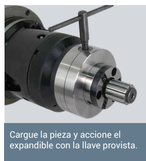
Bloquear el KEM-MA en su posición, ajuste el T.I.R según sea necesario.
