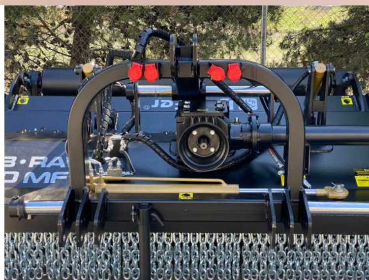
Sistema de desplazamiento hidráulico en paralelogramo
