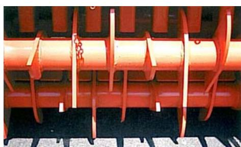
Alimentador accionado mediante motor hidráulico con válvula de regulación de velocidad, piñones y cadena.
