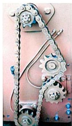
Sistema de alimentación mediante doble pick-para la recogida automática de las ramas. El diseño permite trabajar en terrenos pedregosos sin ningún problema.
