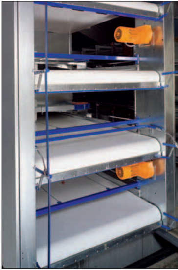
Cabecera final de retirada de estiércol con foso
