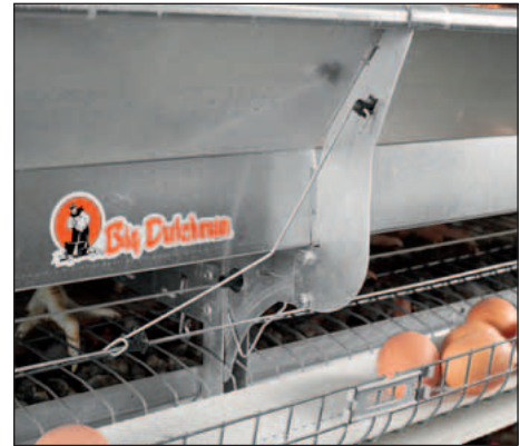
Salva-huevos en posición superior: permite el rodaje hasta la cinta de huevos
