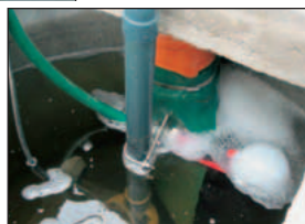
Utilización de una bomba de inmersión para suministro de agua del Coolbox
