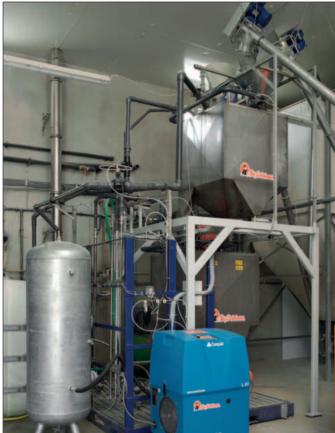
HydroAir-Synchron: este sistema de doble tanque permite una amplia selección entre diferentes recetas que están inmediatamente disponibles para grandes grupos.
