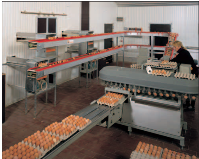
Los huevos llegan a la empaquetadora sobre transportadores de curvas o de varillas
