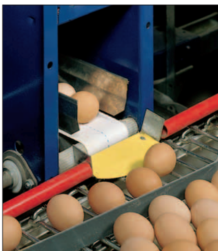
Transferencia de huevos de cinta longitudinal a transversal
