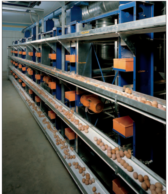
Multipiso: el sistema de recolección de huevos para grandes instalaciones de ponedoras
