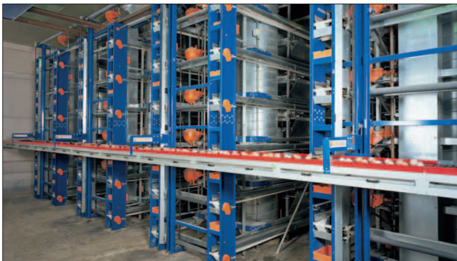
Sistema de recolección de huevos para una instalación de 6 pisos
