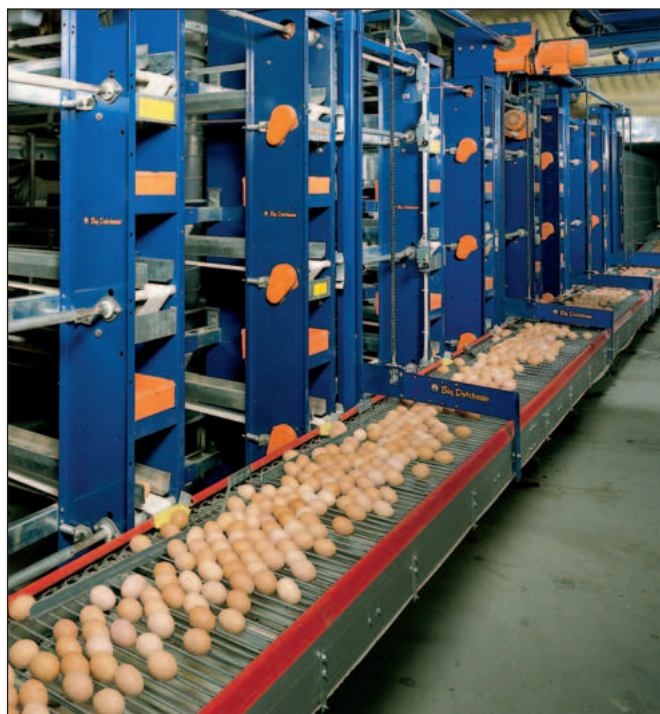
Sistema sube-y-baja: los huevos se recopilan por pisos
