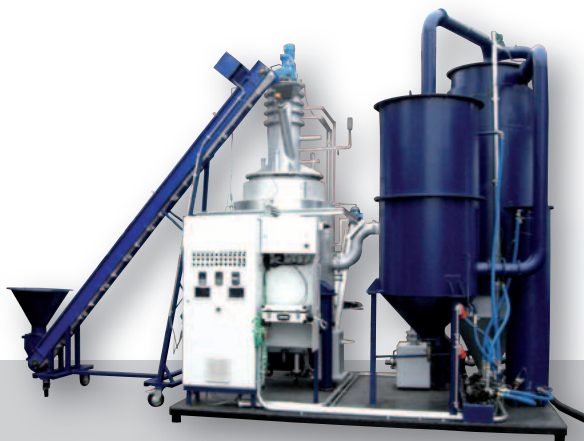
Convertidor termoquímico 150 kW tras montaje final e inspección: cinta transportadora (aporte de pellets), cuadro de control, gasificador, intercambiador de enfriamiento y lavado de gases (de izq. a dch.).
