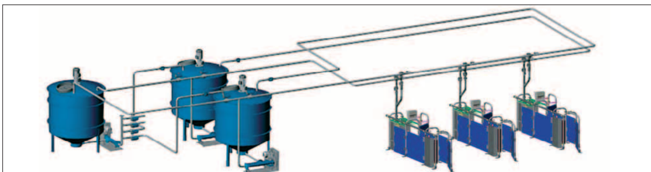
Esquema de funcionamiento de un sistema de alimentación líquida controlado por ordenador con dos tipos de pienso
