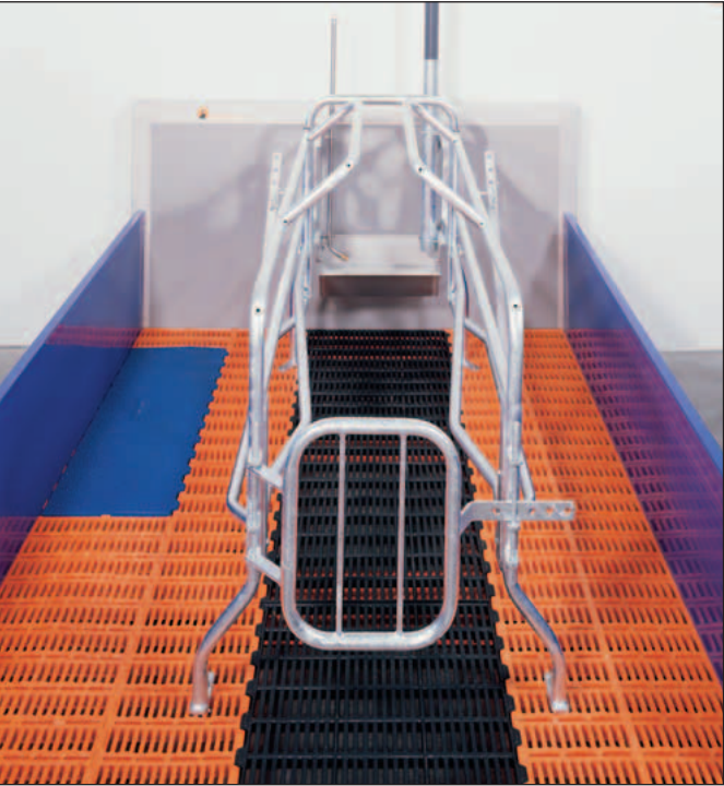
Corral de maternidad con rejilla de fundición en la zona de reposo de la cerda y placa de calefacción de plástico integrada
