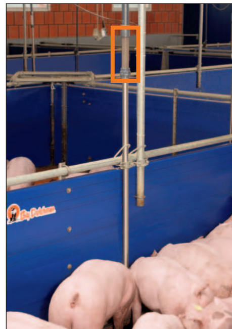
Tubo transparente para controlar el flujo de pienso
