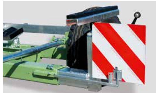
Habachtstellung - Warntafeln sind bei Überbreitentransporten (ab 2,5m) gesetzlich vorgeschrieben (auszieh- und klappbar).
