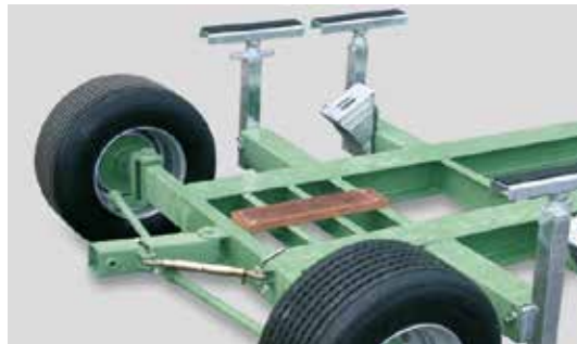
Wendig - Die hintere Lenkachse (auf Wunsch auch hydraulisch ansteuerbar).
