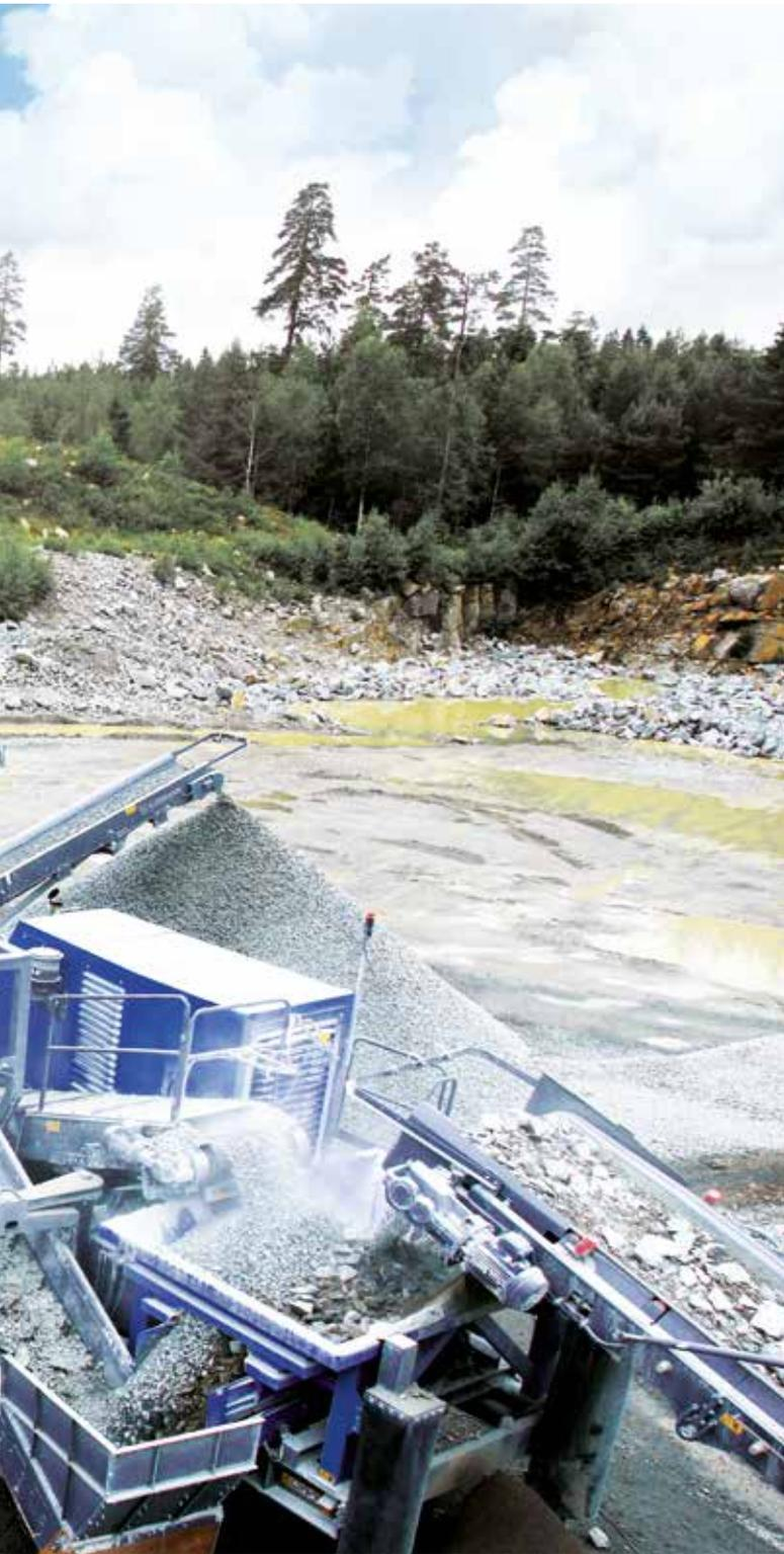
La instalación machacadora de cono móvil MCO 11 S forma parte de los clásicos en la cantera. Eficiente y potente, convence además por ventajas tales como una machacadora robusta, su accionamiento eléctrico diésel, así como su conexión opcional a una fuente de corriente externa. Equipada con una robusta y potente unidad de cribado de cubierta triple, es posible realizar un circuito cerrado. De ese modo, se pueden producir hasta tres granulaciones finales de calidad.
