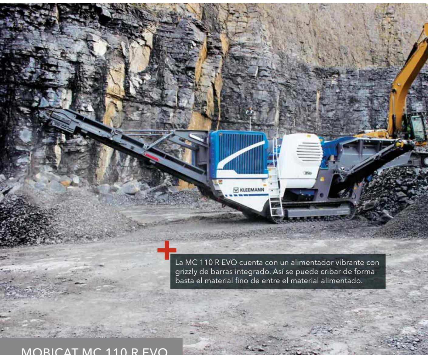
+ La MC 110 R EVO cuenta con un alimentador vibrante con grizzly de barras integrado. Así se puede cribar de forma basta el material fino de entre el material alimentado.
