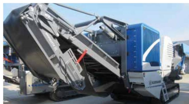
Cinta de descarga de la machacadora más larga para el transporte y fácilmente replegable.
