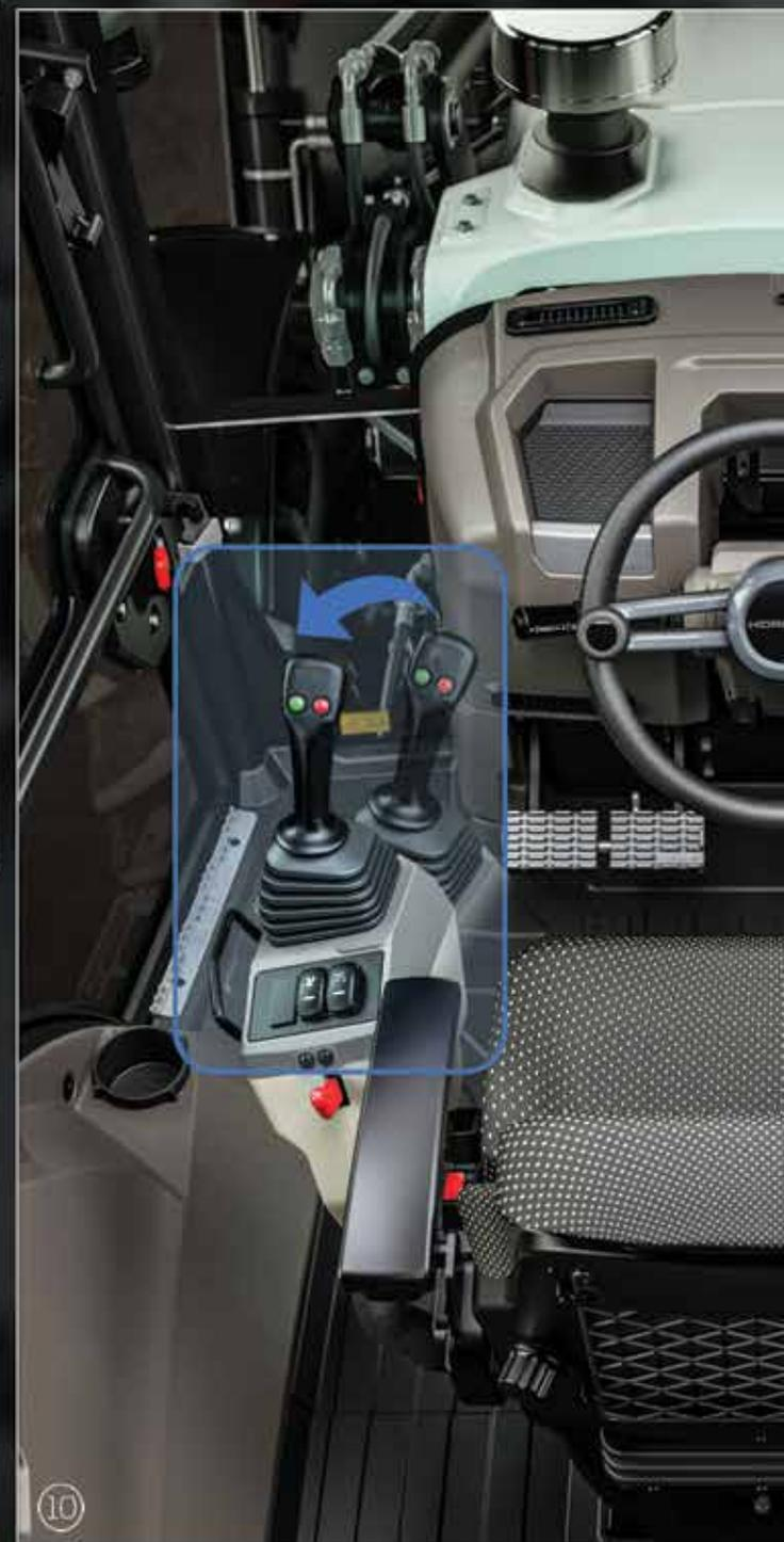
10 El mando izquierdo se inclina hasta cierto grado para que el operador trabaje más cómodamente en el lado de carga
