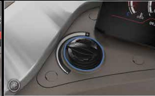
Acelerador manual con control giratorio electrónico (\*\*)
