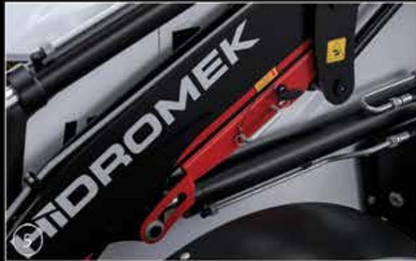
5 Dispositivo de apoyo de pluma de carga
