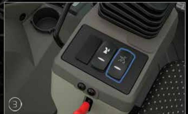
Botón cambiador para función de retroexcavación o de carga
