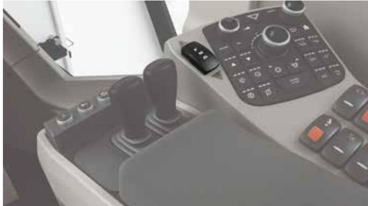
La función **TIPSHIFT** ofrece facilidad de operación al usuario. La dirección se puede cambiar rápidamente con presionar solo una tecla sin utilizar la palanca de cambios cuando la máquina avanza o retrocede, mientras se realiza el trabajo de carga o descarga. Esta característica aumenta la productividad y garantiza un funcionamiento seguro sin perder el control de la dirección.
