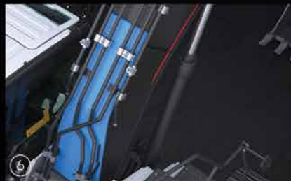
⑥ Estructura de pluma reforzada
