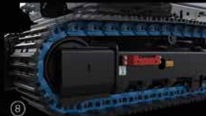
Componentes reforzados del chasis inferior y del tren de rodaje
