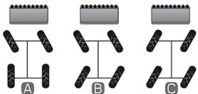
3 diferentes tipos de dirección controlados eléctricamente
