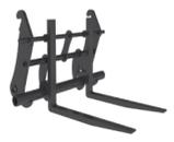
Horquillas adecuadas por el mecanismo del enganche rápido
