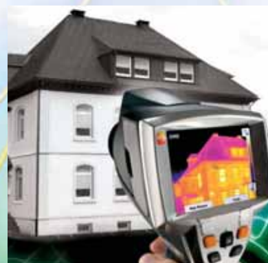
Termografia en edificios
