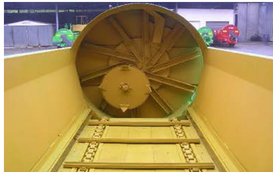
Esparcidor de turbina con rotor de cuchilla y cuchillo raspador.
