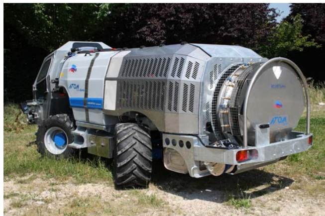
Carrete de manguera trasera con pistola de mano. Luces de trabajo auxiliares LED delanteras y traseras.
