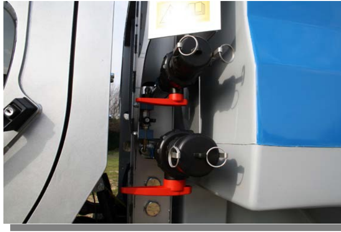
Puntos de llenado del tanque bajo. Sistema venturi de succión de productos químicos.
