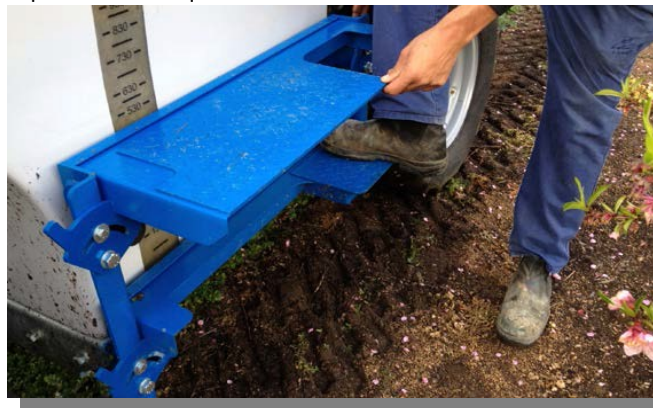
Puntos de llenado del tanque bajo. Sistema venturi de succión de productos químicos.
