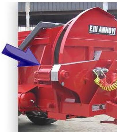
Esparcidor de turbina con 2 rotores,
