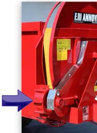
Esparcidor de turbina con rotor de cuchilla y cuchillo raspador.
