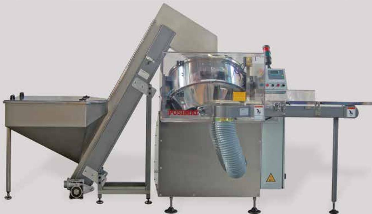
Los posicionadores **MICRO** son diseñados para **envases de reducidas dimensiones** a producciones de hasta 200 bpm. Se trata de un modelo muy compacto fabricado principalmente en acero inoxidable, cuyo cambio de formato se realiza en menos de 5 minutos.
