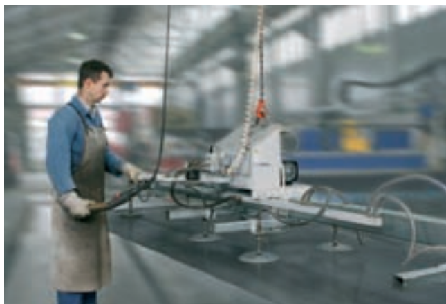
VacuMaster Vario, 1000 kg de capacidad de carga, movimiento horizontal para la alimentación y descarga de instalaciones de corte por plasma
