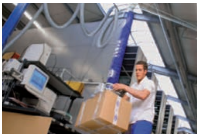
Elevador de tubo por vacío JumboSprint
