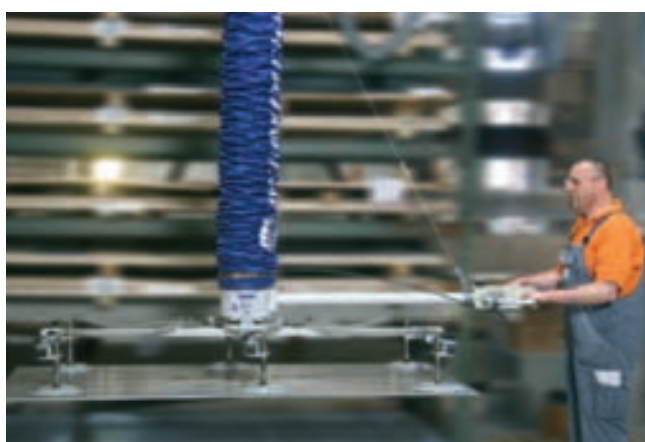
JumboErgo, capacidad de carga de 140 kg, para la preparación de expediciones de chapas de aluminio de formatos medio y pequeño
