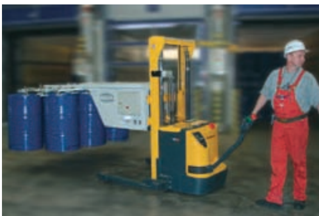
VacuMaster, 140 kg de capacidad de carga, para el transporte de bidones de un punto de descarga de un camión a una cinta transportadora
