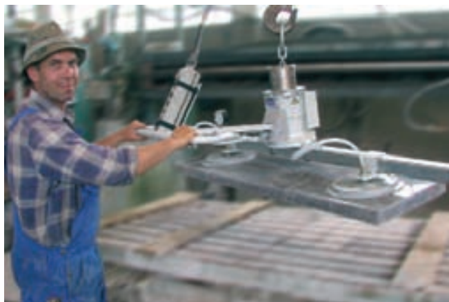
VacuMaster Eco, 250 kg de capacidad de carga, movimiento horizontal para la alimentación y descarga de máquinas de procesamiento de piedra
