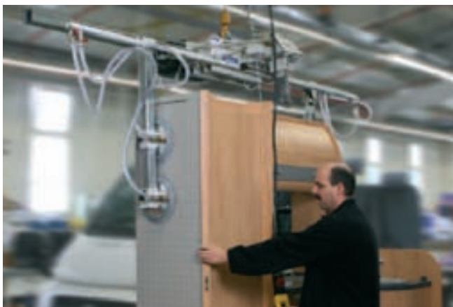
VacuMaster Box, 200 kg de capacidad de carga, para el montaje de elementos de cocina en la construcción de coches-cama
