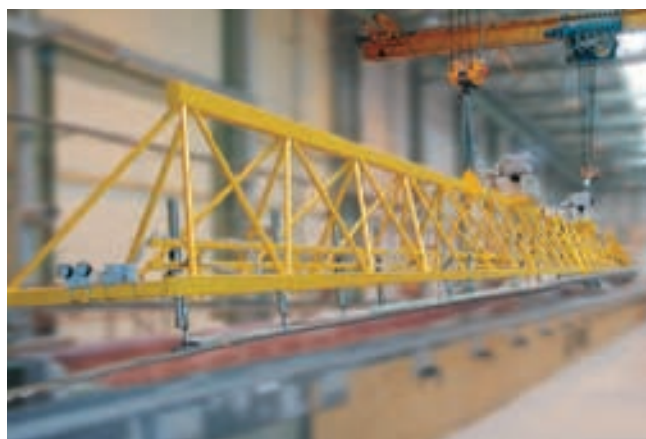
VacuMaster Roto, 1.500 kg de capacidad de carga, para la manipulación de medias envolturas de hojas de rotor
