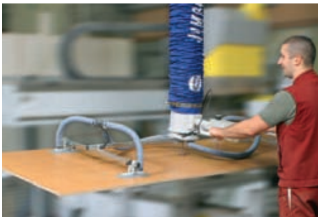
JumboErgo, 85 kg de capacidad de carga, con ventosas cuádruples, para la alimentación y descarga de máquinas de mecanizado de madera con CNC
