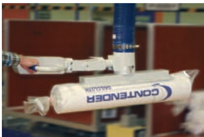
JumboErgo, capacidad de carga de 45 kg, para la preparación de expediciones de rollos textiles envasados en láminas
