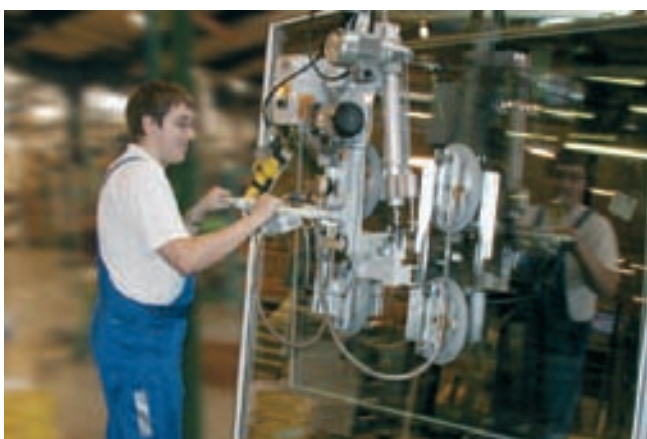
VacuMaster Window, 220 kg de capacidad de carga, para girar lunas de cristal y ventanas completas
