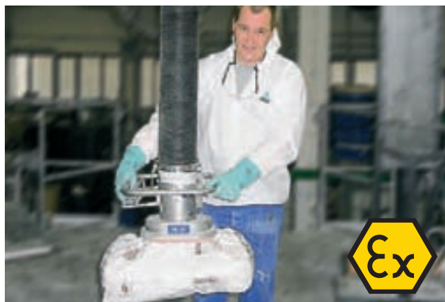
JumboSprint, capacidad de carga de 45 kg, con ventosa para sacos, para la manipulación de sacos en zonas con peligro de explosión según ATEX
