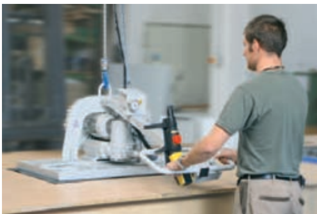
VacuMaster Multi, 400 kg de capacidad de carga, movimiento horizontal para la alimentación de una sierra de una seccionadora
