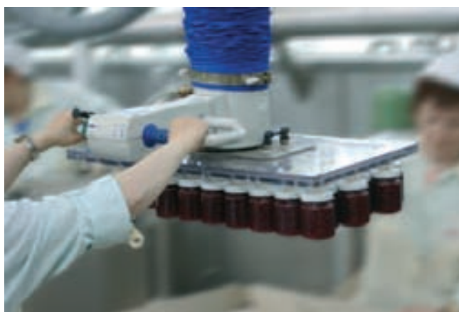
JumboErgo, capacidad de carga de 85 kg, para la manipulación de 48 tarros de confitura
