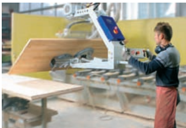
VacuMaster Comfort, 125 kg de capacidad de carga, giro de 180° para la alimentación de centros CNC con planchas de madera encolada
