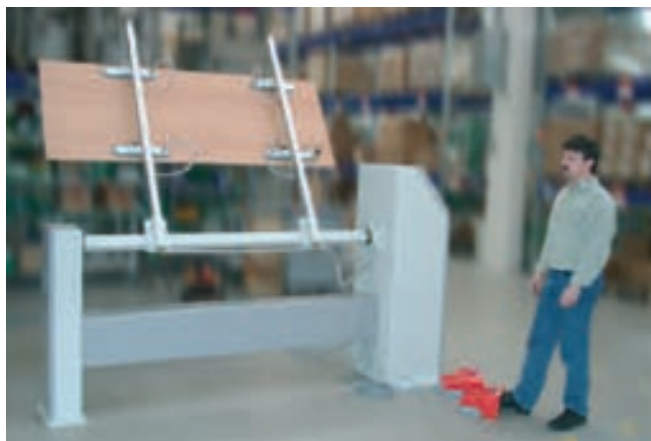
Mesa volteadora con vacío VWT, para el volteo de hasta 180° de piezas
