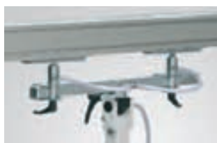
Soporte de trabajo PVS con dos placas de ventosas
