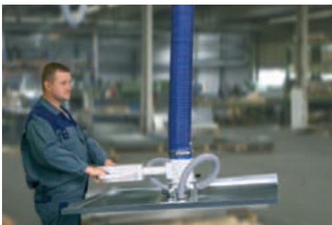
JumboErgo, capacidad de carga de 45 kg, con ventosa doble para la carga de instalaciones de adhesión
