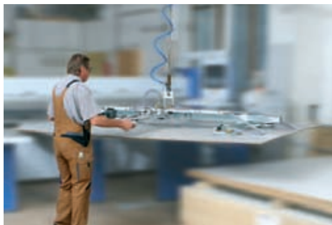
VacuMaster RE, 250 kg de capacidad de carga, para carga de máquinas de procesamiento
