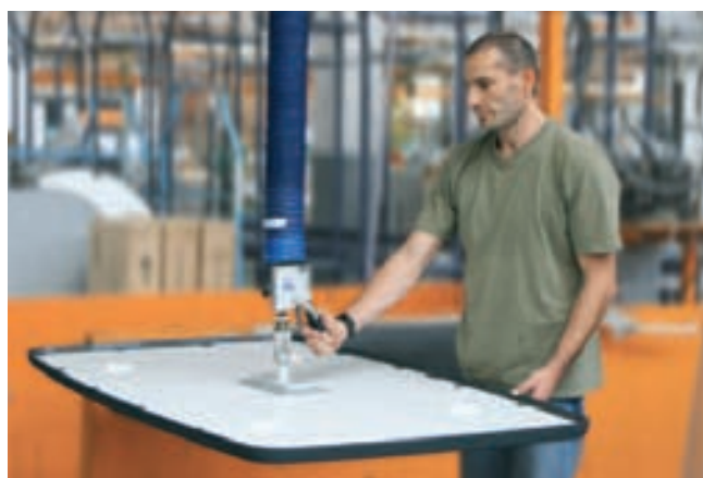
JumboHandy, capacidad de carga de 30 kg, con ventosa simple para preparación de expediciones de mesas de camping
