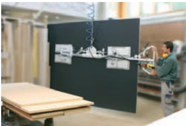
VacuMaster HHVM, 200 kg de capacidad de carga, inclinación de +/- 90° para descarga de planchas almacenadas horizontalmente
