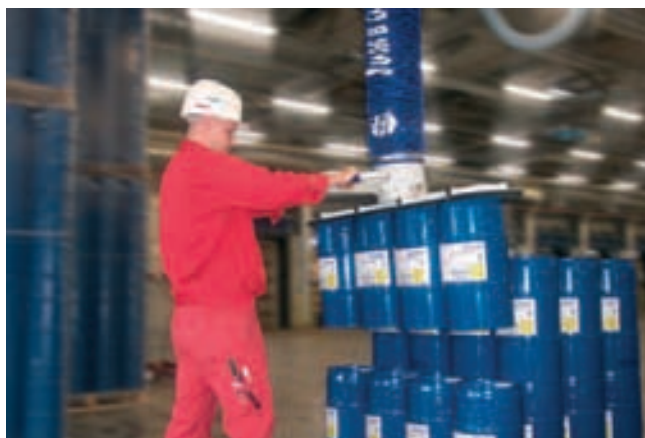
JumboErgo, capacidad de carga de 140 kg, para la manipulación simultánea de 4 bidones
