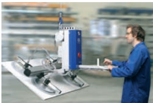
VacuMaster Basic, 250 kg de capacidad de carga, inclinación de 90° para la manipulación de planchas de plástico
