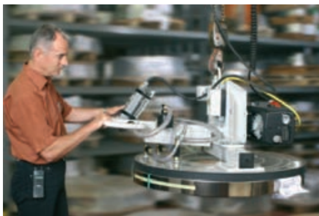
VacuMaster Coil, 750 kg de capacidad de carga, movimiento horizontal, para la manipulación de rollos de acero inoxidable
