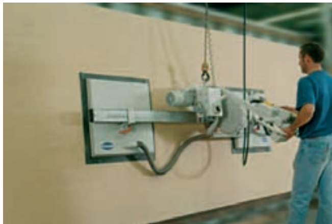
VacuMaster Multi, 300 kg de capacidad de carga, ideal para la carga de sierras verticales
