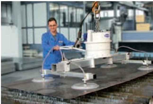
VacuMaster Eco, 1000 kg de capacidad de carga, horizontal para la alimentación y descarga de máquinas de corte por láser
