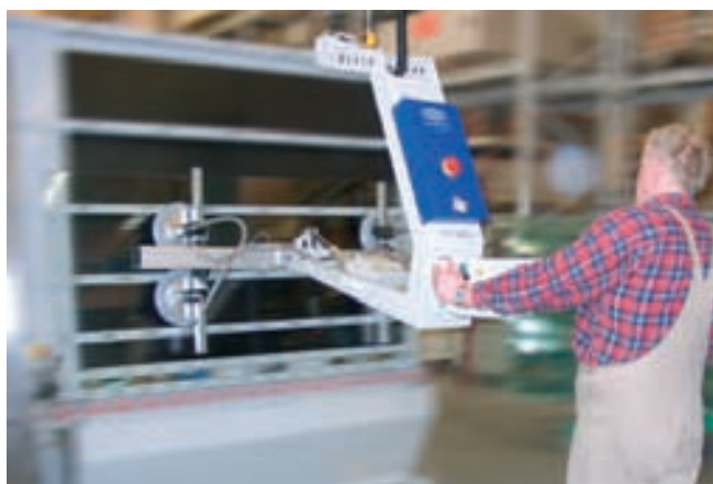
VacuMaster Comfort, 125 kg de capacidad de carga, con giro de 180° para la manipulación de lunas de cristal
