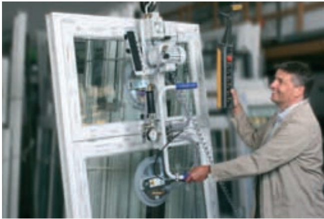
VacuMaster Window, 170 kg de capacidad de carga, movimiento vertical para la manipulación de ventanas de varias alas
