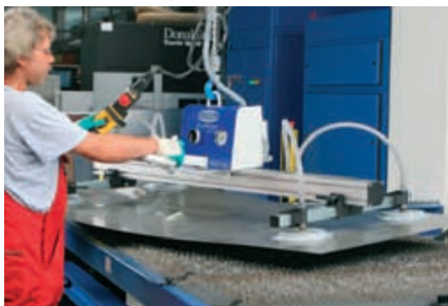
Aparato elevador por vacío VacuMaster Basic
