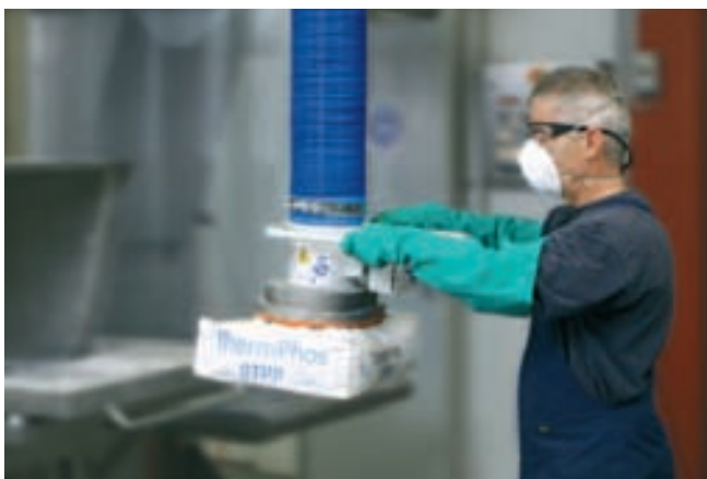
JumboSprint, capacidad de carga de 65 kg, con ventosa para sacos, para la manipulación de sacos de plástico y de papel
