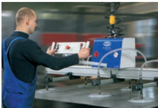
VacuMaster Comfort, 750 kg de capacidad de carga, movimiento horizontal para la manipulación de chapas metálicas
