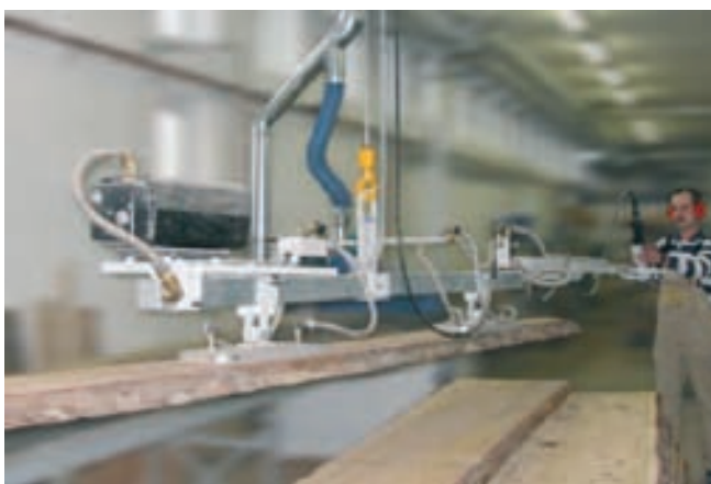
VacuMaster VHB, 500 kg de capacidad de carga, para la manipulación de tabloncillos de sierra rugosos
