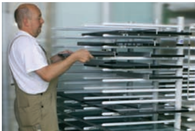
Carro de secado HW para el depósito y transporte de piezas
