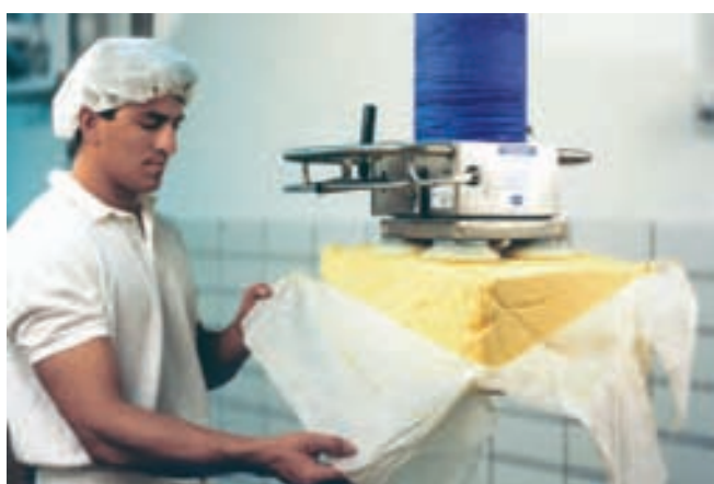
JumboSprint, capacidad de carga de 65 kg, ejecución en acero inoxidable, para la manipulación de alimentos
