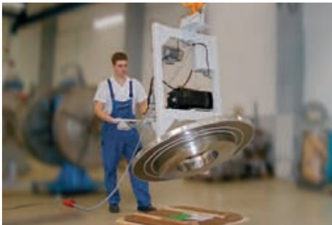
VacuMaster Coil, 750 kg de capacidad de carga, inclinación de 90° para la manipulación de rollos y bobinas de fleje metálico
