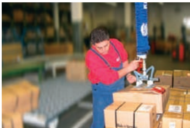
JumboHandy, capacidad de carga de 30 kg, con ventosa doble, para la manipulación de cartones
