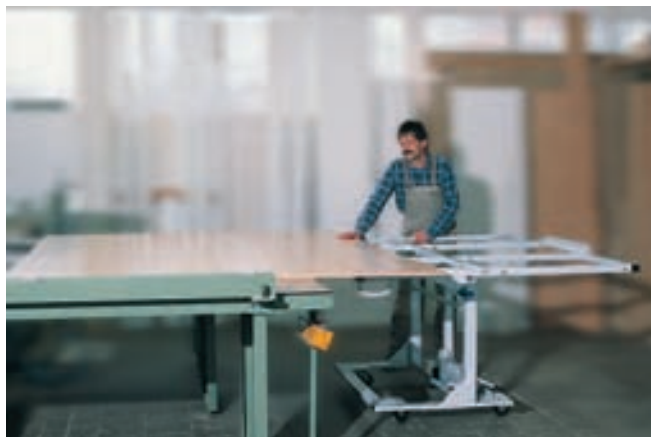
Carro de transporte de placas PTS 250 para recogida de placas desde la vertical
