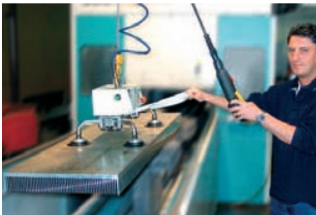
VacuMaster Light, 100 kg de capacidad de carga, movimiento horizontal para la alimentación y descarga de máquinas de procesamiento con CNC
