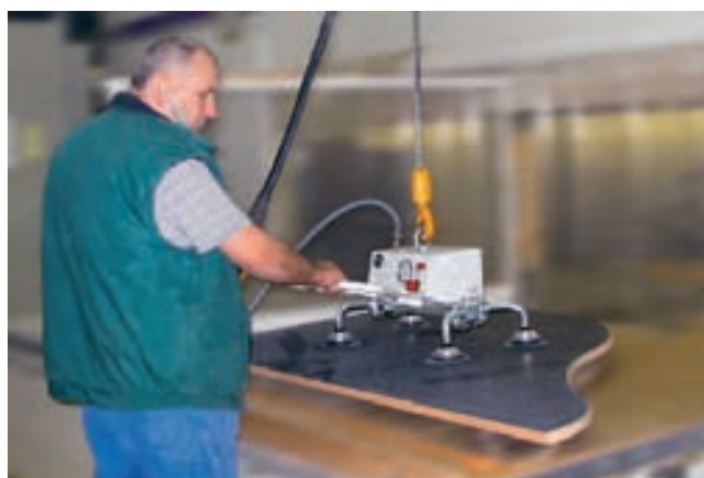
VacuMaster Light, 100 kg de capacidad de carga, movimiento horizontal para la alimentación de máquinas
