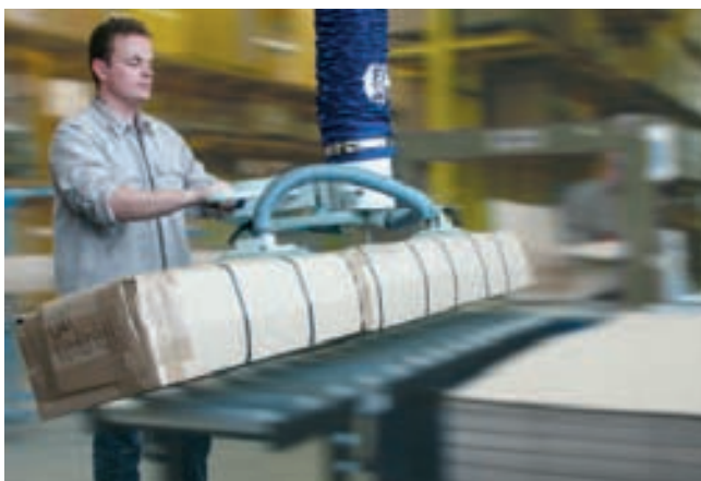
JumboErgo, capacidad de carga de 85 kg, con ventosa doble, para la manipulación de cartones con una longitud de hasta 4 m
