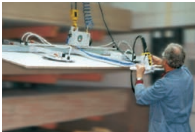
VacuMaster RE, 250 kg de capacidad de carga, movimiento horizontal para la descarga de planchas de madera de estanterías de brazos en voladizo y para la alimentación a continuación de centros de mecanizado de madera con CNC
