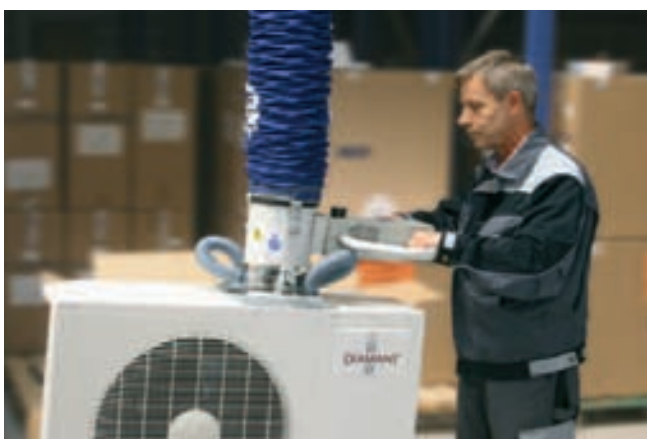
JumboErgo, capacidad de carga de 85 kg, con ventosa doble para la manipulación de aparatos de aire acondicionado
