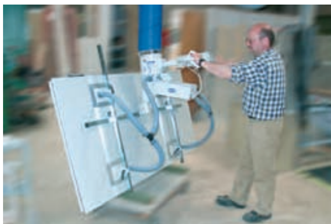
JumboErgo, capacidad de carga de 90 kg, con unidad de inclinación neumática y ventosa cuádruple, para la manipulación de planchas de madera
