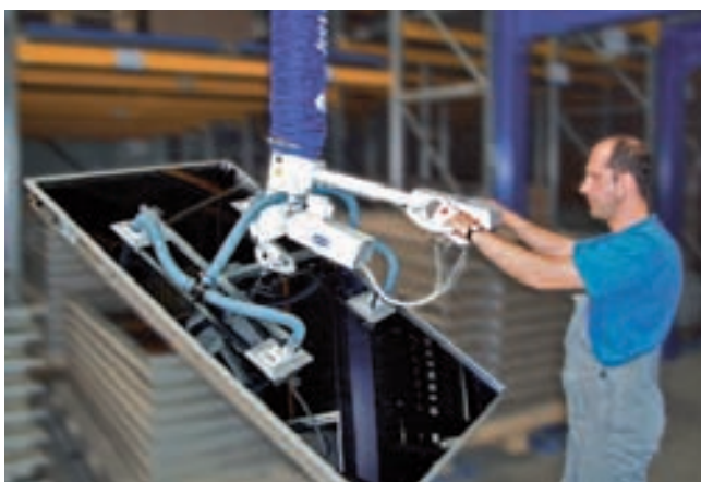
JumboErgo, capacidad de carga de 85 kg, con unidad neumática de inclinación, para la recogida horizontal de células solares y depósito vertical sobre un carro de preparación de expediciones
