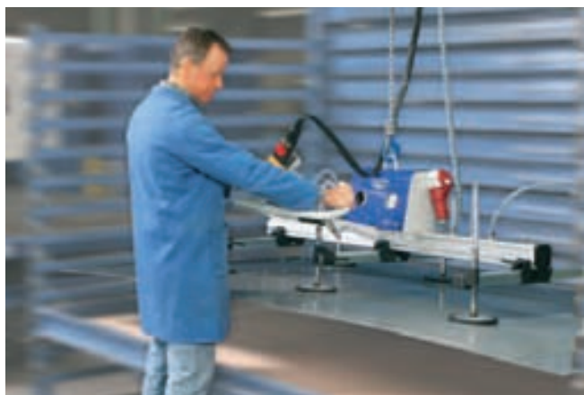
VacuMaster Basic, 250 kg de capacidad de carga, movimiento horizontal para la alimentación y descarga de sistemas de estanterías de chapa
