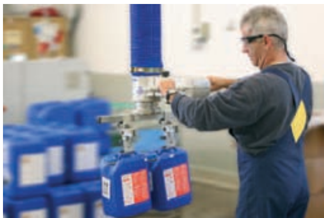
JumboErgo, capacidad de carga de 45 kg, para el apilado de garrafas en la cinta de rodillos
