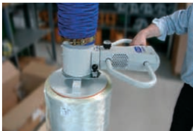
JumboErgo, capacidad de carga de 65 kg, con ventosa redonda para la manipulación de rollos de lámina
