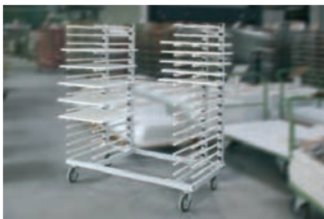
Carro de secado HWV para el depósito y transporte de piezas
