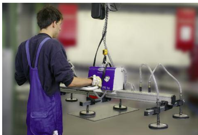
VacuMaster Basic, 250 kg de capacidad de carga, horizontal para la manipulación de planchas de formato pequeño o planchas con recortes mediante ventosas que se pueden desconectar individualmente (más información en p. 7)
