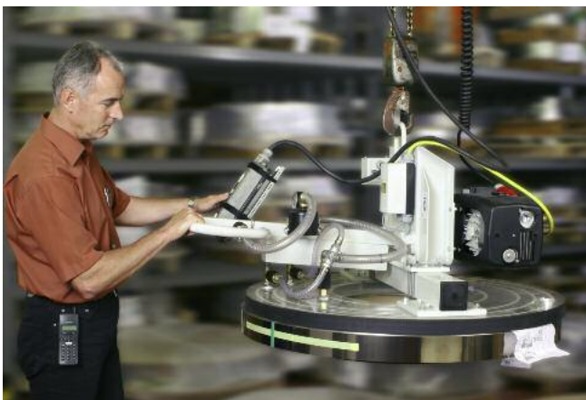
VacuMaster Coil, 750 kg de capacidad de carga, horizontal para la manipulación de bobinas de acero inoxidable (más información en p. 8)
