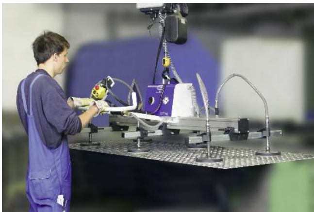
VacuMaster Basic, 250 kg de capacidad de carga, horizontal para la manipulación de chapas corrugadas (más información en p. 7)
