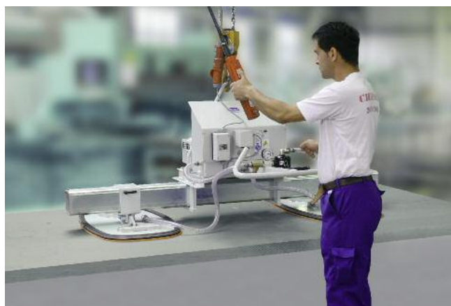
VacuMaster Vario, 2000 kg de capacidad de carga, horizontal para la alimentación de una sierra con planchas de aluminio grandes (más información en p. 8)
