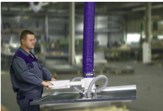
JumboErgo, 45 kg de capacidad de carga, con ventosas dobles FM para la alimentación de instalaciones de adhesión (más información en p. 6)
