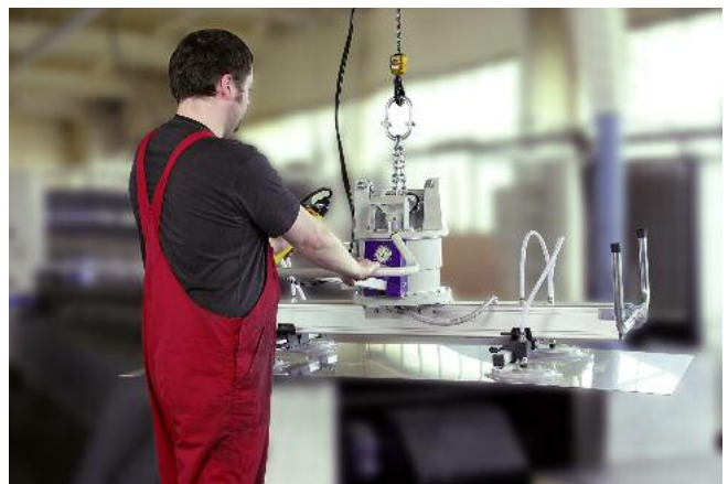
VacuMaster Eco, 500 kg de capacidad de carga con pies de apoyo, para la alimentación de máquinas de corte por láser (más información en p. 7)
