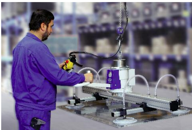
VacuMaster Eco, 250 kg de capacidad de carga, horizontal para la manipulación sin energía externa de chapas
