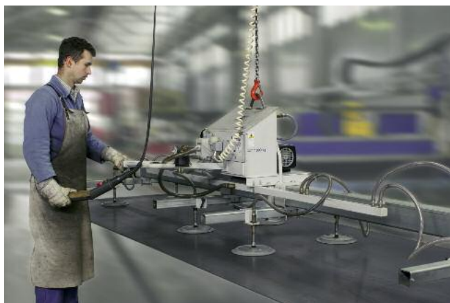
VacuMaster Vario, 1000 kg de capacidad de carga, horizontal para la alimentación y descarga de instalaciones de corte por plasma
