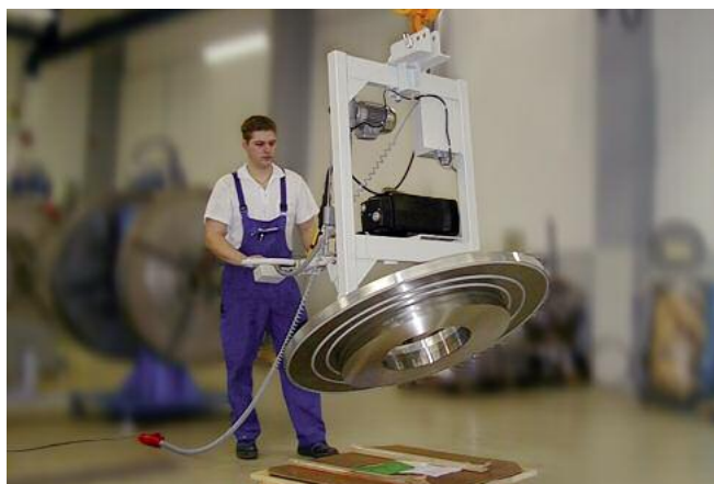
VacuMaster Coil, 750 kg de capacidad de carga, con giro de 90°, para la manipulación de bobinas
