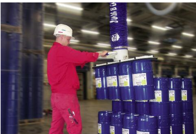
JumboErgo, 140 kg de capacidad de carga, con solución de ventosas específica del cliente para la manipulación simultánea de 4 bidones (más información en p. 6)
