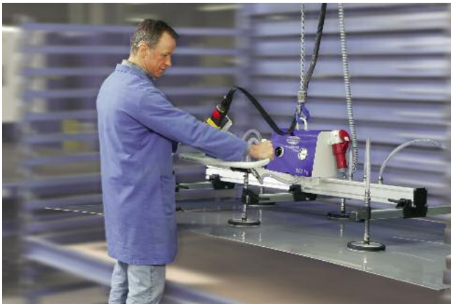
VacuMaster Basic, 250 kg de capacidad de carga, horizontal para la alimentación y descarga de sistemas de estanterías de chapa (más información en p. 7)
