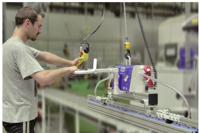
VacuMaster Basic, 100 kg de capacidad de carga, horizontal para la manipulación de perfiles de aluminio (más información en p. 7)
