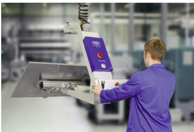
VacuMaster Comfort, 125 kg de capacidad de carga, con volteo de 180° para la manipulación de chapas (más información en p. 7)
