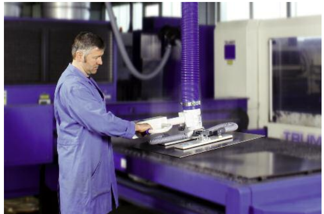
JumboErgo, 35 kg de capacidad de carga, con ventosas dobles FM para el transporte seguro de placas en bruto, así como chapas base recortadas (más información en p. 6)
