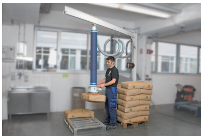
JumboSprint, capacidad de carga de 65 kg, con ventosa para sacos, para la preparación de expediciones de sacos de plástico y de papel
