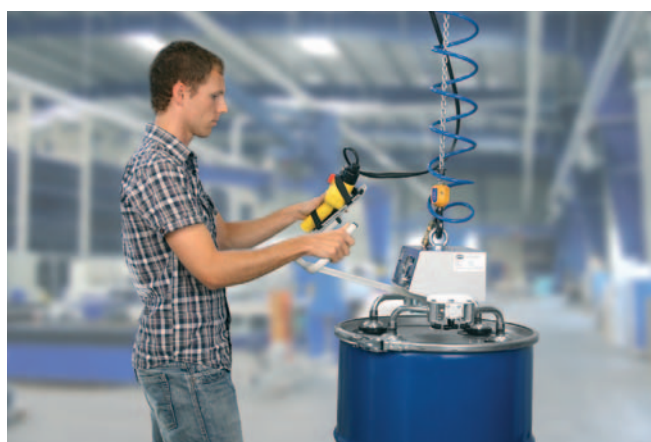
VacuMaster Eco, capacidad de carga de 250kg, horizontal para la manipulación de bidones
