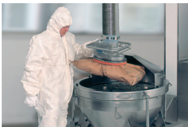
JumboSprint, capacidad de carga de 65 kg, con ventosa para sacos, para la manipulación de sacos en zonas con peligro de explosión según ATEX
