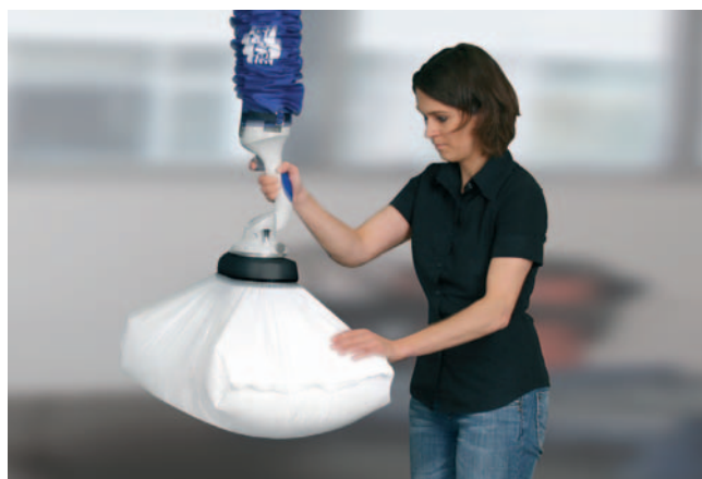
JumboFlex, capacidad de carga de 35 kg, con ventosa para sacos, para la manipulación de sacos de plástico de hasta 25 kg
