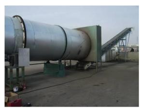
Este es el tipo de secado universal por excelencia y consiste básicamente en un tambor rotativo en el que se introduce tanto el producto a secar como el fluido térmico de secado a una temperatura elevada. En función de la utilización del fluido térmico tenemos dos posibilidades de plantas: las de secado directo e indirecto, con capacidades de evaporación de hasta 25.000 litros/hora.
