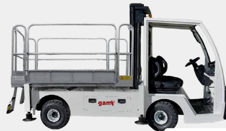
TRACCIÓN Y ELEVACIÓN ELÉCTRICA Traslado de dos operarios en cabina Altura entierro 4,5 m y 5,5 m
