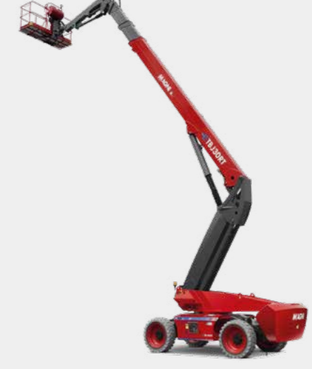
Eléctrica o Híbrida de 16 m a 44m (de 22 m a 44 m batería litio)
