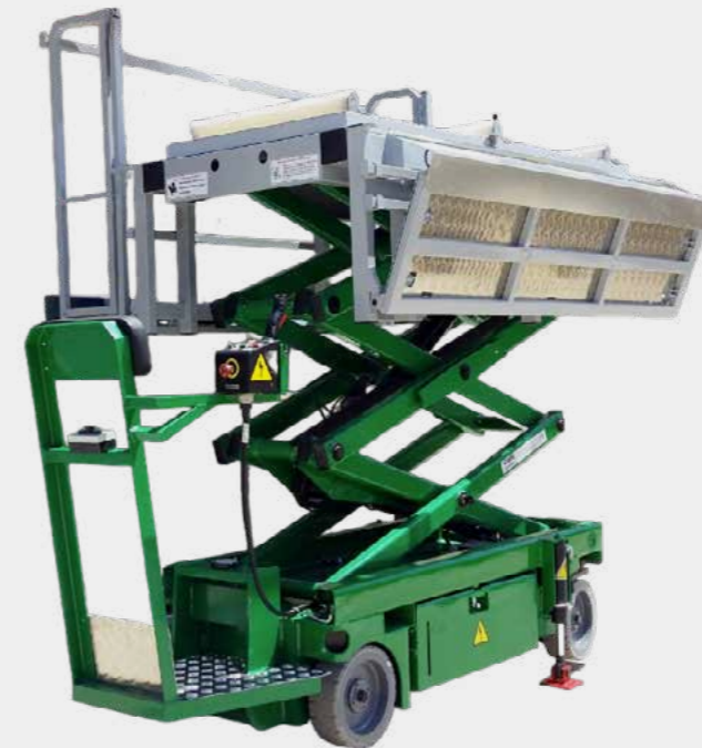
TRACCIÓN Y ELEVACIÓN ELÉCTRICA Operario sobre máquina o a pie Altura entierro 4,5 m y 5,5 m
