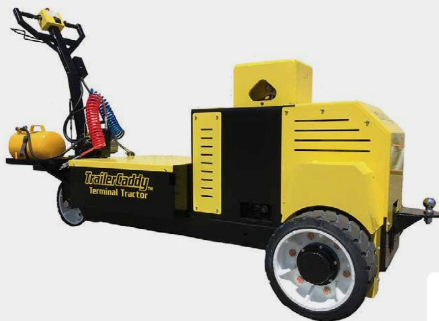
A6k 36v Arrastre 45 ton Elevación 13.6 ton
