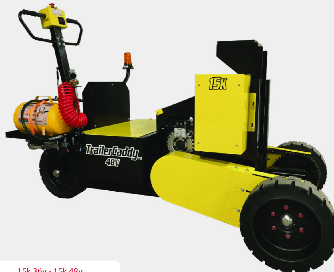
15k 36v - 15k 48v Arrastre 22.6 ton Elevación 6.8 ton
