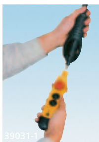
Desplazar la protección por el cable de mando hacia arriba
