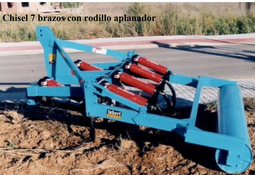
Los chisels TUBERT destacan por su gran eficacia en su trabajo. Se fabrican modelos para una potencia de 70 a 180 cv. Hay disponibles modelos de 5, 7, 9, 11, 13 y 15 brazos de 40 x 40 distribuidos en 2 o 3 líneas.
