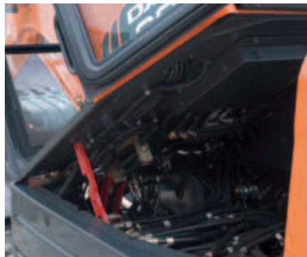
Cabina abatible para un fácil mantenimiento
