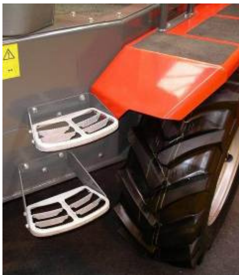
Estribo AUF/12 en dumper NEUSON-KRAMER
