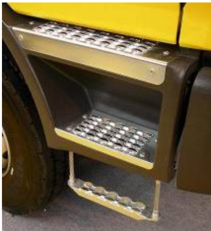
Estribo AUF/Stabil 330 en camión de ASTRA
