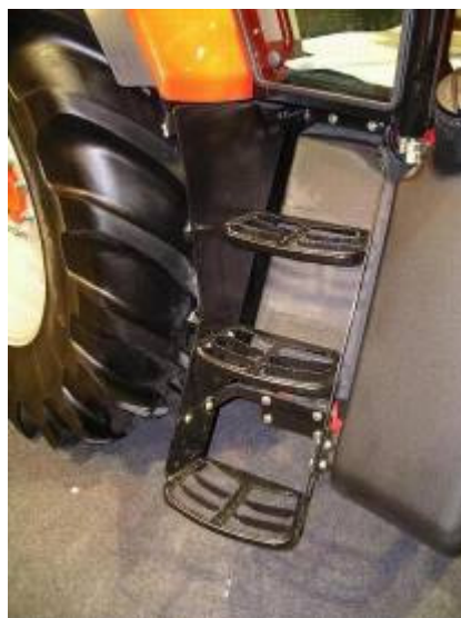
Estribo AUF/12 en tractor McCORMICK
