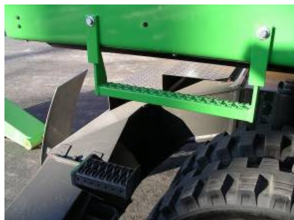
Estribo a excavadora con peldaño LO/6K
