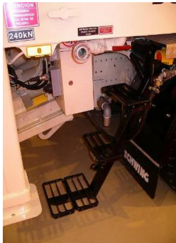
Acceso a bomba de hormigón sobre camión "SCHWING"
