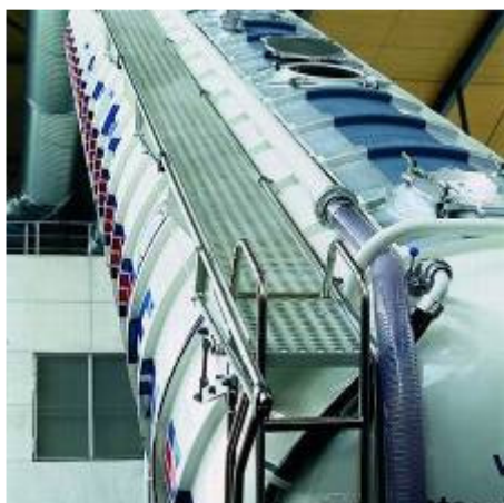
Pasarela STABIL con borde lateral en camión cisterna con escalera de acceso.
