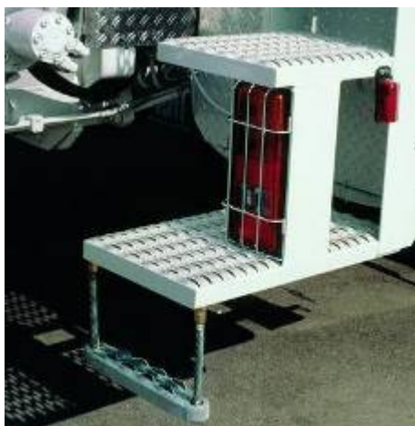
Estribo AUF/Stabil 330 en bomba de hormigón de PUTZMEISTER
