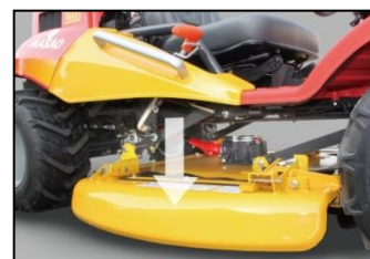
Ajuste de la altura de corte deseada
