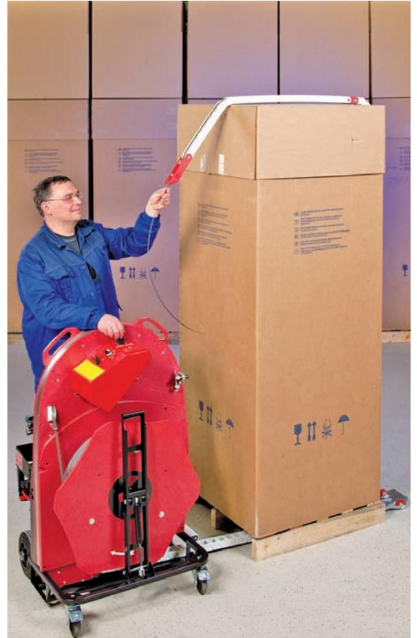
Los materiales a embalar elevados tampoco son un problema para los sistemas ErgoPack: con un complemento puede realizar el flejado seguro y rápido de palets de hasta 3,0 m de altura.
